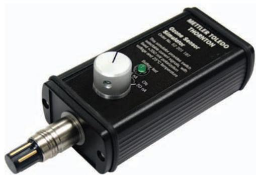
Il est possible d'accélérer le démarrage du système d'ozonisation Mettler-Toledo Thornton à l'aide du simulateur de sonde d'ozone. Le simulateur remplace la sonde et génère des signaux de niveau d'ozone et de température sans qu'une génération d'ozone ou la polarisation de la sonde ne soient nécessaires. Il permet de vérifier les mesures (sauf pour la sonde) avant le démarrage du système de traitement.
