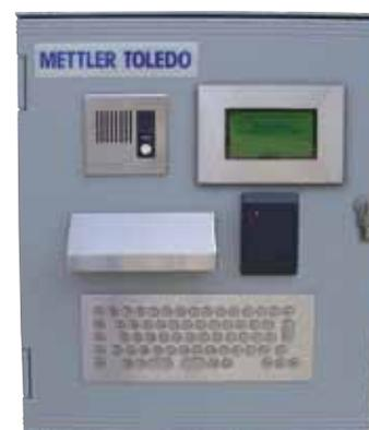
Les bornes de pesée IND9UO assurent la fluidité du trafic sur les ponts-bascules en permettant aux chauffeurs de procéder à leurs propres transactions de pesage en quelques secondes.
