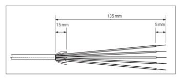
Dénuder le câble de cellule conformément la figure ci-contre.
