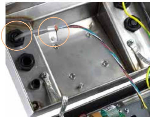
Figura 2-27: Passaggio del cavo della cella di carico nella scocca del terminale IND236, con il fermaglio di terra.
