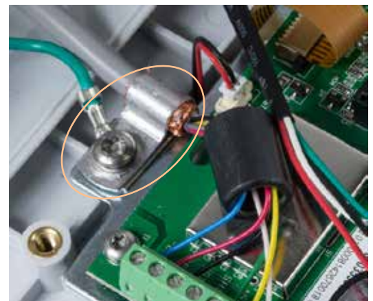
Figure 2-23 : Installation de la ferrite du câble d'un capteur analogique avec mise à la masse sur le châssis, IND231
