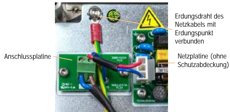
Abbildung 2-18: IND236 – Netzplatine und Erdung
