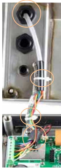
Abbildung 2-24: Stifterung der analogen Wägezelle und Ferritperleninstallation, IND236
