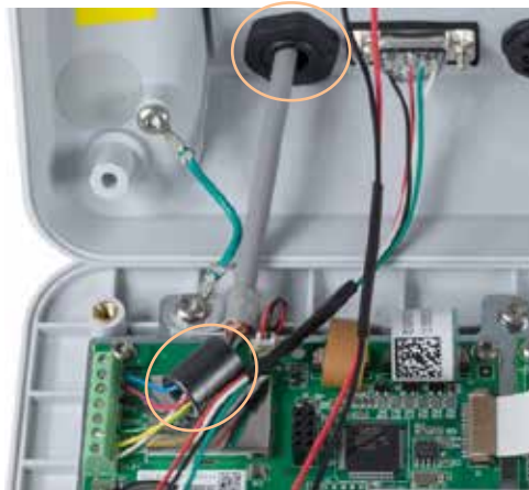
Figure 2-23 : Installation de la ferrite du câble d'un capteur analogique avec mise à la masse sur le châssis, IND231
