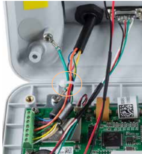
Figura 2-20: Installazione del terminale di messa a terra e della ferrite per la cella di carico analogica, IND231
