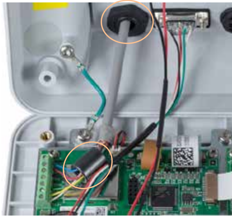
Abbildung 2-23: Ferritperleninstallation und Gehäuseerdung des analogen Wägezellenkabels, IND231
