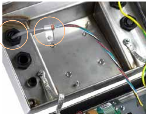
Figura 2-27: Cabo da Célula de Carga do Gabinete do IND236, com Clipe de Aterramento do Chassi
