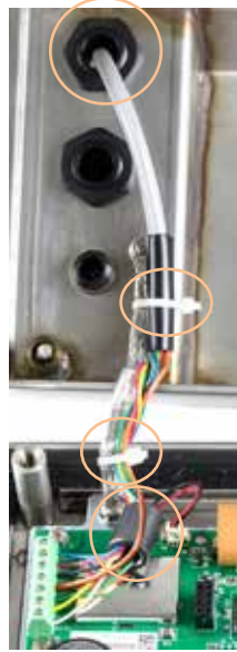
Figura 2-24: Conexión a tierra de la patilla de la celda de carga analógica e instalación de la ferrita, IND236
