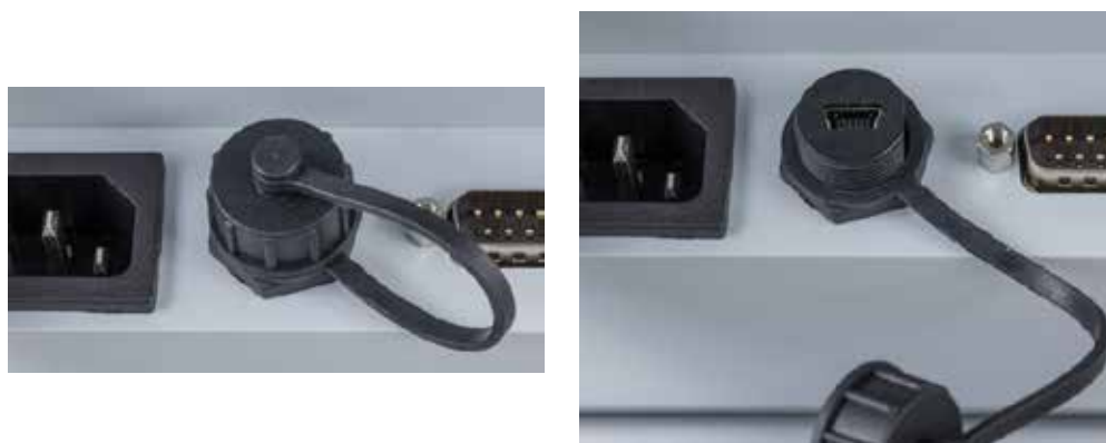
Figura 2-35: Tampa e Soquete de Mini USB
