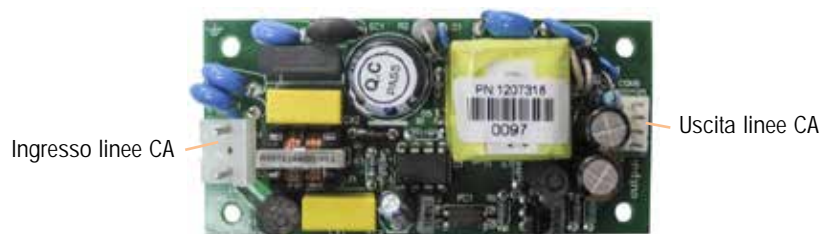
Figura 2-17: Scheda di alimentazione
