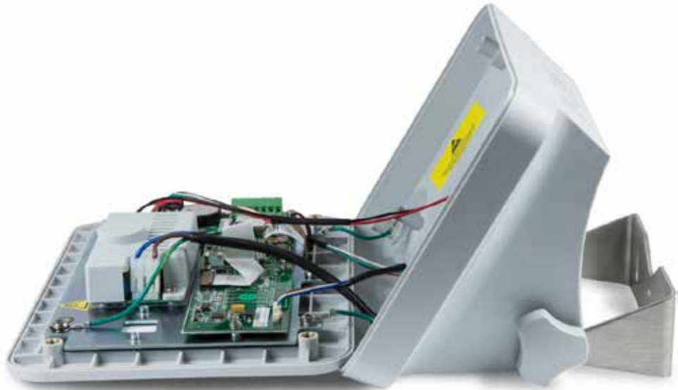
Figura 2-3: Remoção da Tampa
