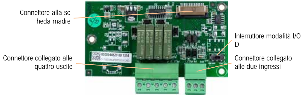
Figura 2-36: Scheda opzionale I/O discreto
