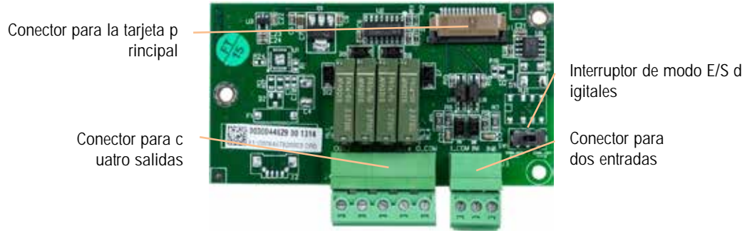
Figura 2-36: Tarjeta opcional de E/S discretas
