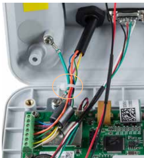
Figura 2-20: Conexión a tierra de la patilla de la celda de carga analógica e instalación de la ferrita, IND231
