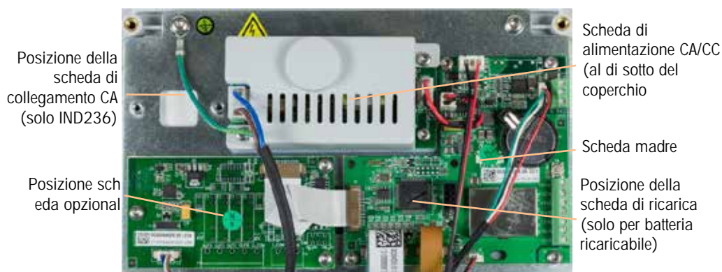
Figura 2-15: Posizioni schede elettroniche
