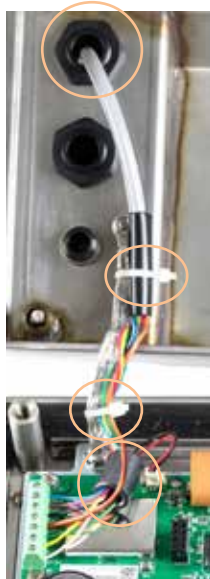
Figura 2-24: Instalação de Ferrite e Pino Terra da Célula de Carga Analógica, IND236
