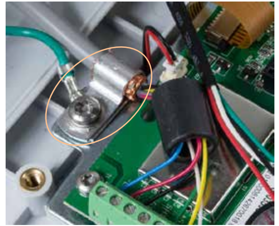
Abbildung 2-23: Ferritperleninstallation und Gehäuseerdung des analogen Wägezellenkabels, IND231
