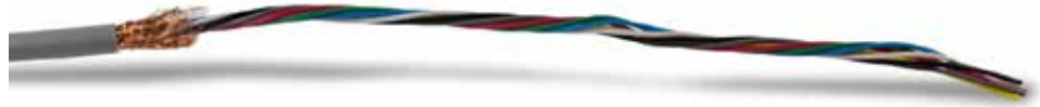
Figura 2-25: Cable de la celda de carga con el blindaje exterior removido y el alambre del blindaje recortado
