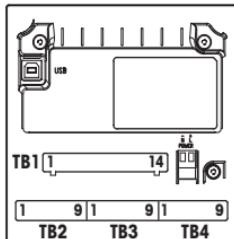
**Remarque:** il s'agit d'un produit à 4 fils avec une sortie analogique active 4–20 mA. Merci de ne pas alimenter les bornes 1–6 du TB2.
