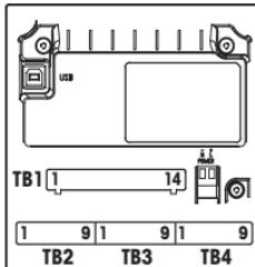
**Nota:** si tratta di un prodotto a 4 fili con uscita analogica 4-20 mA. Non fornire corrente ai pin 1-6 del TB2.
