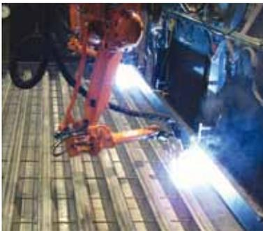
Les modules sont soudés par des robots afin de répondre aux normes de qualité les plus élevées.
