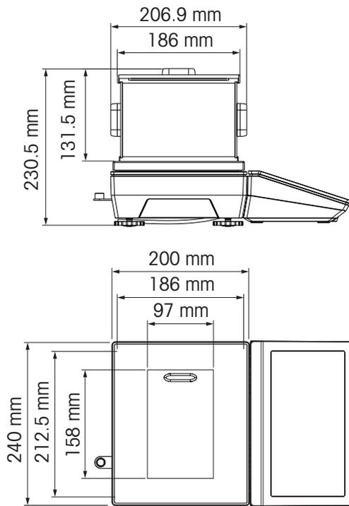
**Balança compacta ICS4\_5 com plataforma de pesagem LA**
