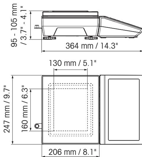
**Balança compacta ICS4\_5 com plataforma de pesagem XS e pára-brisa**
