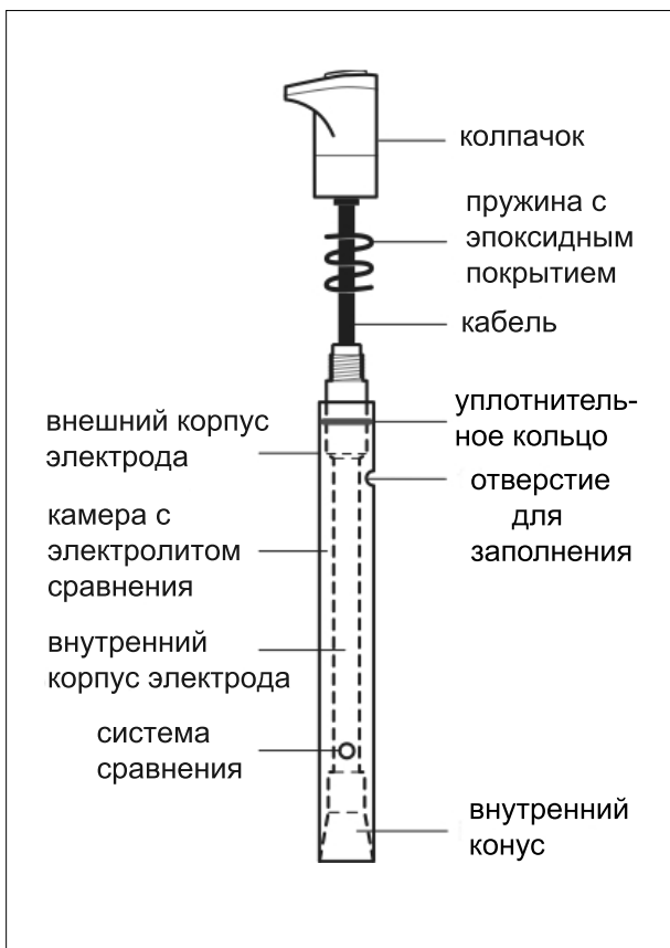
Рис. 1. Комбинированный свинцовый электрод perfetION™
