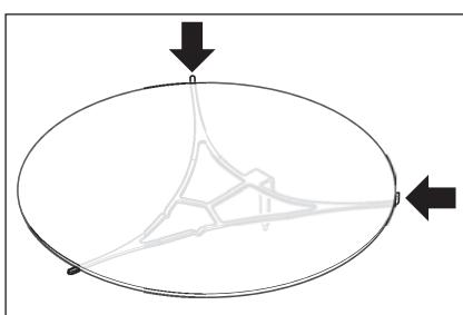
Posez le filtre **exactement au centre**, de telle sorte qu'il repose au niveau des deux ergots verticaux des bras arrière du porte-filtre.
