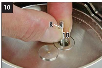
Poser le support de porte-filtre (10). **Important:** La partie plus courte, biseautée (K) en haut sur le support de porte-filtre doit être orientée vers l'avant de la balance!
