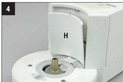
Dichtungsklappe (H) entfernen.
