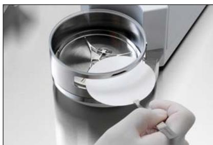
Führen Sie den Filter **seitlich** durch die Öffnung in den Windschutz ein. Wir empfehlen Ihnen, mit **Handschuhen** zu arbeiten. Sie vermeiden damit die Übertragung der Körperwärme in den Messraum und kommen so schneller zu einem genauen Resultat.
