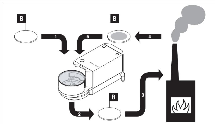
Avec la méthode simple, un seul **filtre de mesure** (B) est utilisé.
