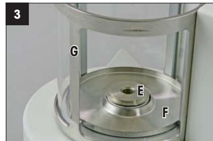
Desenrosque la montura (E), retire el plato colector (F) y levante el corta-aires de vidrio (G).
