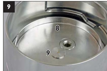
Filterschale (8) einsetzen und Rändelmutter (9) aufschrauben.
