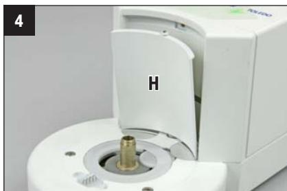
Retire la cubierta de hermetización (H).
