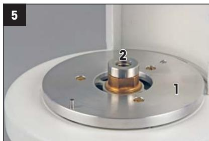
Kupplung (1) einsetzen und Positioniermutter (2) aufschrauben.
