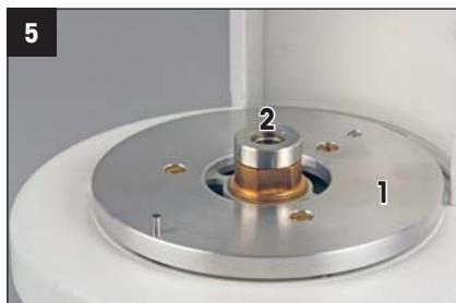
Insérer le disque de liaison (1) et visser l'écrou de positionnement (2).
