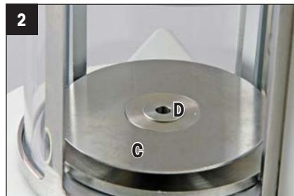
Soulever le socle intermédiaire (C) et la douille (D).
