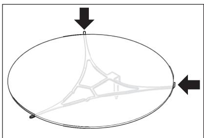
Deposite el filtro **exactamente en el centro**, de modo que esté en contacto con los dos salientes verticales de los brazos posteriores del platillo para filtros.
