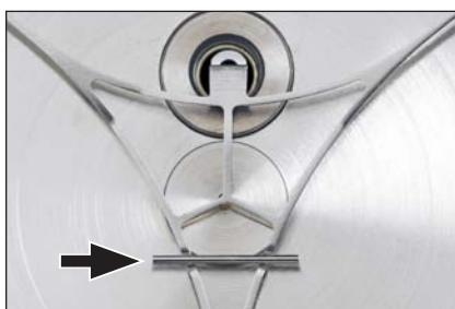
Für die **Justierung der Waage** oder deren Überprüfung können Sie das eingebaute oder ein externes Gewicht verwenden.
