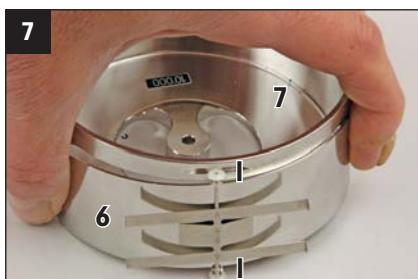
Coloque la cubierta de hermetización (6) sobre el corta-aires (7) y fíjela. Asegúrese de que las ruedecillas (I) se sitúan en las ranuras del corta-aires.
