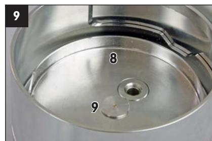
Poser le plateau à filtre (8) et visser l'écrou moleté (9). Effectuer un test de fonctionnement du pare-brise à l'aide des touches de commande de porte (ouverture vers la gauche ou la droite).
