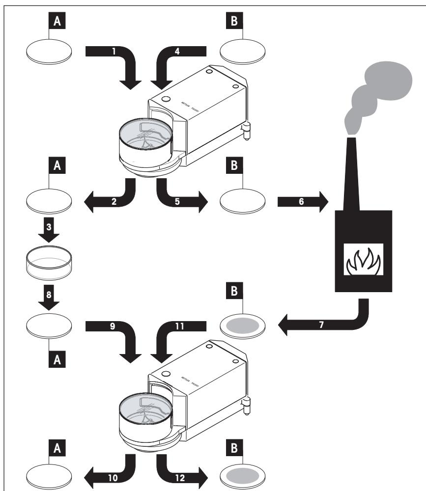
Diese Methode berücksichtigt auch Änderungen der Umgebungsbedingungen und die mögliche Kontaminierung des Messraums. Dazu werden 2 Filter verwendet, ein **Referenzfilter** (A) und ein **Prüffilter** (B).
