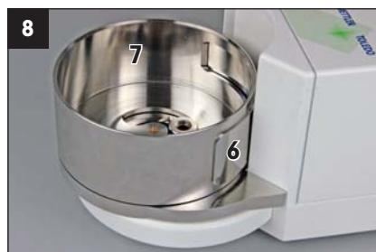
Monte juntos el corta-aires (7) y la cubierta de hermetización (6) y apriete hacia abajo. Gire ligeramente el corta-aires hasta que encaje (el manguito guía (5) debe alojarse en la ranura del lado inferior del corta-aires).
