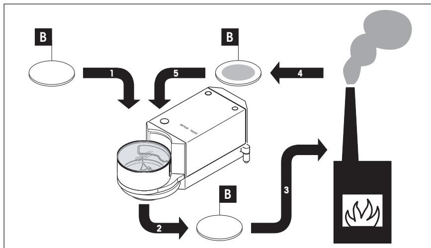
Bei der einfachen Methode wird nur ein **Prüffilter** (B) verwendet.
