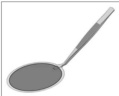
Le kit pour le pesage de filtres est livré avec une **pincette** spéciale. Pour les pesées de filtres, nous vous recommandons d'utiliser exclusivement cette pincette. Le bec supérieur est plus court, ceci évite que la pincette ne vienne en contact avec la matière déposée sur le filtre. Le bec inférieur, plus long assure un maintien stable du filtre sur la pincette.
