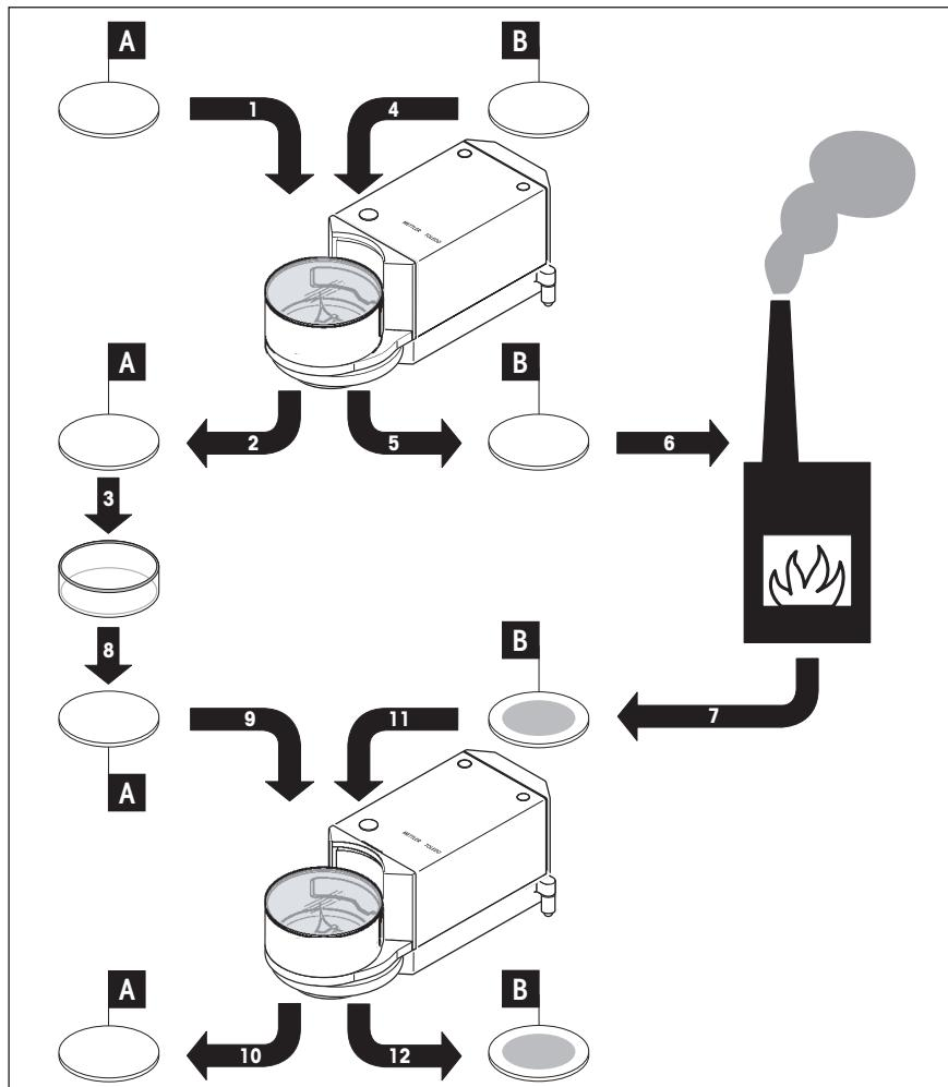
Este método tiene en cuenta también cambios en las condiciones ambientales y la posible contaminación de la cámara de pesada. Para ello se utilizan 2 filtros, un **filtro de referencia** (A) y un **filtro de ensayo** (B).
