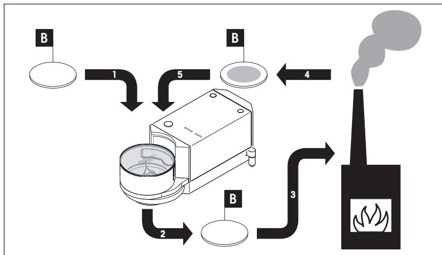
Para el método simple se utiliza solamente un **filtro de ensayo** (B).
