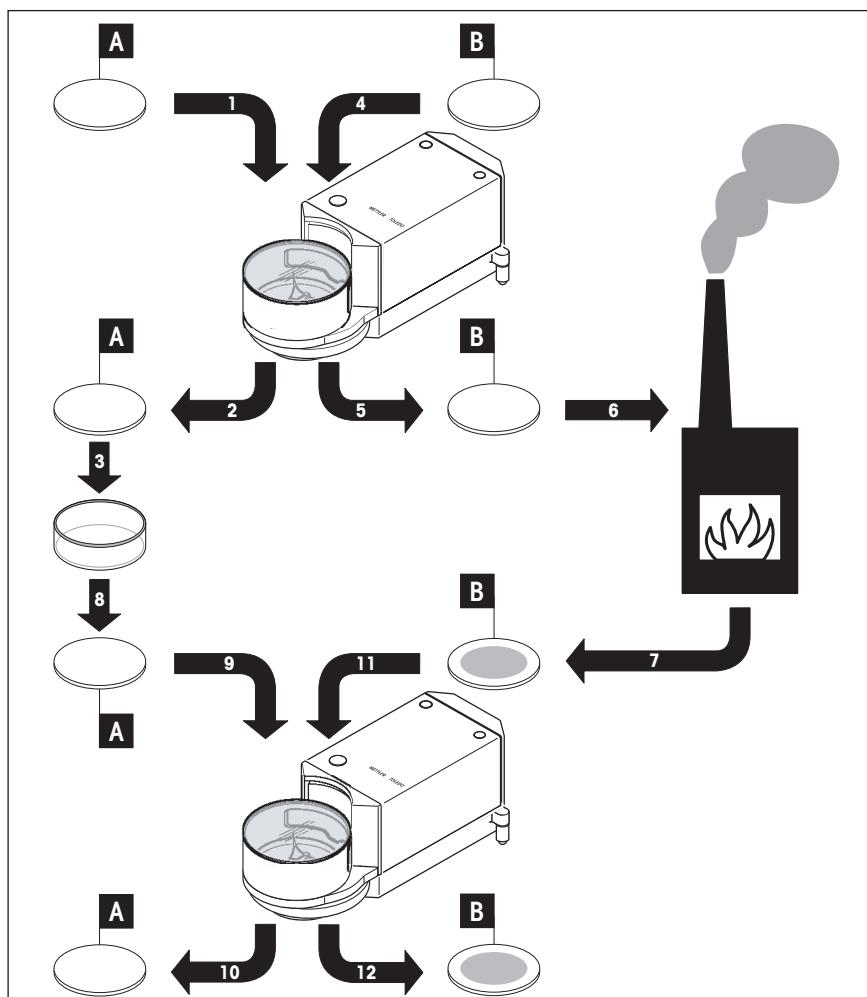
Cette méthode tient aussi compte de modifications des conditions ambiantes et de l'encrassement possible de la chambre de mesure. Pour cela, 2 filtres sont utilisés, un **filtre de référence** (A) et un **filtre de mesure** (B).
