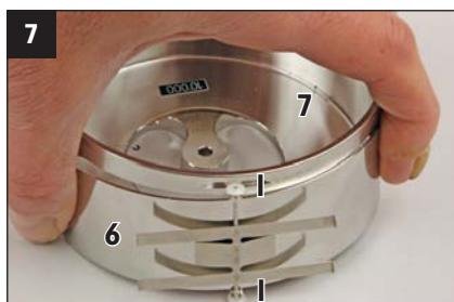
Poser et maintenir le volet de fermeture (6) sur le pare-brise (7). Ensuite, veiller à ce que les petites roues (I) soient placées dans les rainures du pare-brise.
