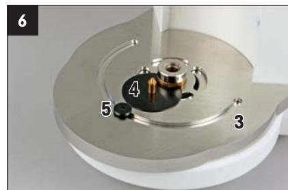
Coloque la base de deslizamiento (3) y el manguito guía (5). Inserte la arandela (4) en el eje de latón de la base.
