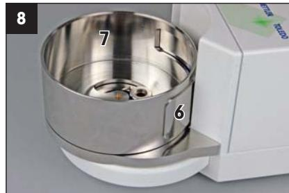
Windschutz (7) und Dichtungsklappe (6) zusammen einsetzen und nach unten drücken. Windschutz leicht drehen, bis er reinrastet (die Gleitbuchse (5) muss in der Nut auf der Unterseite des Windschutzes liegen).
