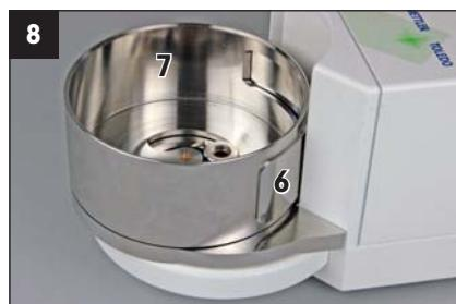
Insérer ensemble le pare-brise (7) et le volet de fermeture (6) et les presser vers le bas. Tourner légèrement le pare-brise, jusqu'à ce qu'il s'engage (la douille de guidage (5) doit reposer dans la rainure sur la face inférieure du pare-brise).
