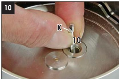
Schalthalter (10) einsetzen. **Wichtig:** Der kürzere, abgeschrägte Teil (K) oben am Schalthalter muss zur Vorderseite der Waage zeigen!
