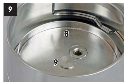
Coloque el plato del filtro (8) y enrosque la tuerca moleteada (9). Realice una prueba de funcionamiento del corta-aires con las teclas de la puerta de la balanza (abrir a izquierda y derecha).
