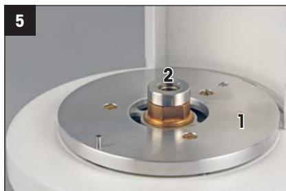
Coloque el acoplamiento (1) y enrosque la tuerca de posición (2).
