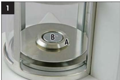
Windring (A) und Waagschale (B) abheben.
