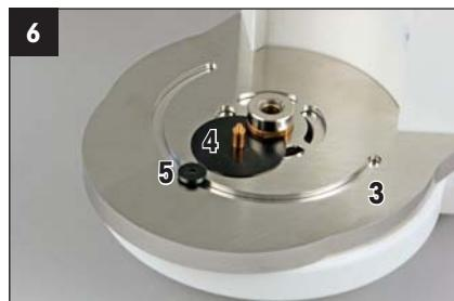
Poser le socle de guidage (3) et la douille (5). Placer le disque de guidage (4) sur l'axe laiton du socle de guidage.
