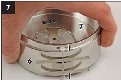
Dichtungsklappe (6) an Windschutz (7) ansetzen und festhalten. Darauf achten dass die Rädchen (I) in den Nuten des Windschutzes liegen.
