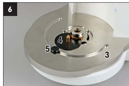
Gleitboden (3) und Gleitbuchse (5) einsetzen. Gleitscheibe (4) auf Messingachse des Gleitbodens aufsetzen.
