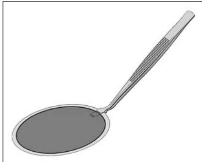
Das Filterset wird mit einer speziellen **Pinzette** ausgeliefert. Wir empfehlen Ihnen, für Filterwägungen ausschliesslich diese Pinzette zu verwenden. Die obere Zunge ist verkürzt, dies verhindert, dass die Pinzette mit dem auf dem Filter abgelagerten Material in Berührung kommt. Die untere, längere Zunge sorgt für einen stabilen Halt des Filters in der Pinzette.
