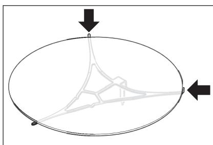
Legen Sie den Filter **exakt mittig** auf, so dass er an den beiden vertikalen Nocken an den hinteren Auslegern der Filter-Waagschale anliegt.
