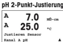
Drücken Sie im Messmodus die Taste [CAL]. Falls das Display Sie zur Eingabe des Sicherheitscodes für die Justierung auffordert, drücken Sie zur Einrichtung dieses Codes auf die Taste ▲ oder ▼. Drücken Sie anschliessend auf die Taste [ENTER], um den Sicherheitscode für die Justierung zu bestätigen.
