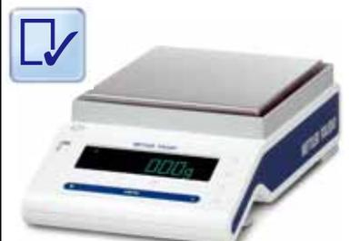
内蔵分銅を使用した繰り返し性テスト※や、キーパッドテスト、ディスプレイテストなどの診断機能を搭載。簡易的な天びん機能テストを簡単操作で実施できます。
