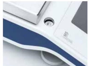
天びんの水平状態は計量の正確さに大きく影響します。水平状態を簡単に確認、調整できるよう、水準器と水平調整脚を天びん前側に設置。水平調整が簡単にできます。
