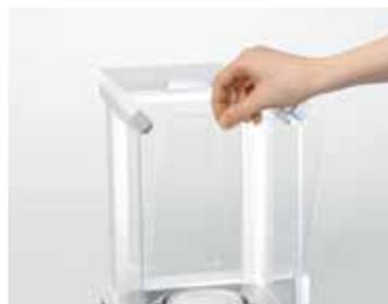
最小表示 1mg 以下の天びんに搭載の風防は、風防ガラスを簡単に取り外せる特殊構造。だから、定期的に必要な天びんの掃除に長時間を要せず、計量作業により集中できます。
