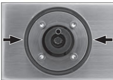
▶ モジュールを床下計量用へ変更するには、オプションのカバー（床下計量キットについては、WMS 計量モジュール・アクセサリ (52 ページ) をご覧ください）および T10 Torx ドライバーが必要です。
