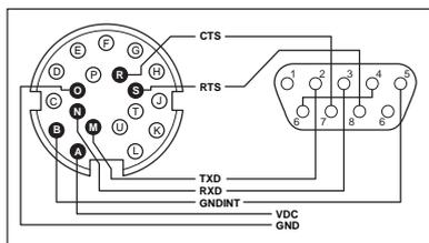
ソフトウェアは RS232C インターフェイスを介してダウンロードできます。D-sub9 ピン接続端子の DTR ライン (4 ピン) と DSR ライン (6 ピン) が接続されていることを確かめてください。WMS ConBlock を使用している場合、この接続はすでに D-sub9 ピン接続端子に組み込み済みです。WMS ConBlock (56 ページ) を **ご覧ください**。
