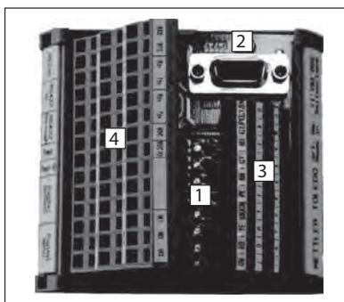
WMS ConBlock は DIN レールを介した取り付けを前提に設計されており、WMS計量モジュールの接続を容易にします。
