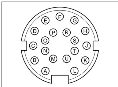
以下のケーブル・グループは 19 ピン接続端子を介して機器の入出力端子に接続されます。
