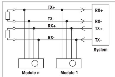
複数の計量モジュールを使用する場合、それぞれの送信線および受信線を簡単に並列接続することでネットワークを構築し、設備システムから最大 31 基のモジュールをただ 1 個の RS422 インターフェイスを介して制御可能です。最大許容ケーブル長さおよび転送速度は、RS422 インターフェイスの規格（100 kb/s にて 1,200 m）に対応しています。先端と末端に接続してある WMS 計量モジュールにおいて、“M45” **MT-SICS コマンド** を使って終末抵抗アダプタのスイッチを入れる必要があります。
