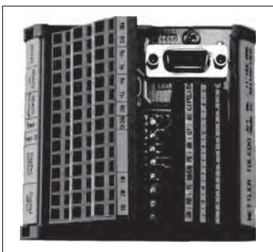
最後に、ConBlock に電源を投入します。電源は WMS 計量モジュールの初期スタートアップに十分な容量を備えています。
