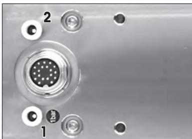
“ウォッシュダウン”オプション作動用のエア接続口 (1) にはマーキングが施されています。1 bar (±0.1 bar) の定圧を使用してください。2 番目のエア接続口 (2) は排気用です。
