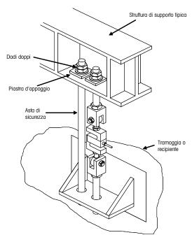
Vite a perno e dadi di fissaggio (come mostrato) tipici di tutti i moduli eccetto quello da 7500 kg. Questa capacità utilizza un perno con testa ad innesto in sostituzione della vite a
