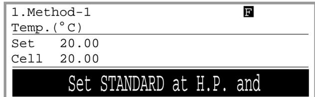
Nun werden Sie aufgefordert, die Probenzufuhrgeschwindigkeit für den Standard festzulegen. Wählen Sie "Low" (niedrig) für "Sampling Speed?", wenn Sie einen Standard mit einer niedrigen Viskosität (z.B. Wasser) oder "High" (hoch) wenn Sie einen Standard mit einer hohen Viskosität einsetzen mit der ◀ oder ▶-Taste und bestätigen Sie mit <Enter>. Bestätigen Sie "Exit:[Execute]" mit <Enter>.
