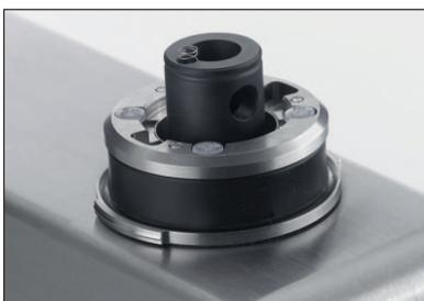
La fonctionnalité « lavage » préconfigurée se présente sous la forme d'un jeu de joints situé sous la plate-forme de pesage et activé par pression d'air. Elle permet le nettoyage du module au jet d'eau tout en protégeant la sonde de pesage de la surcharge dynamique, sachant que, lorsqu'elle est activée, elle bloque la plate-forme de pesage.
