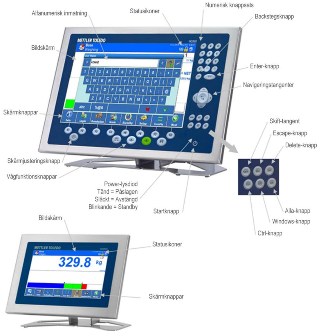
Åtta funktionsknappar har arrangerats under skärmen. Användaren kan använda dessa knappar för att navigera genom installationsalternativen i menystrukturen och installations- och programskärmar.
