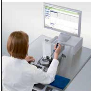
Una mesa de pesaje de doble bastidor opcional reduce al mínimo cualquier vibración procedente del entorno o del usuario, lo que a su vez acelera considerablemente los tiempos de medición. Gracias a esta completa solución, la calibración de pipetas es más rápida que nunca.
