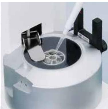
La tapa del sensor de movimiento y la trampa de evaporación de gran tamaño (80 ml) del XPE26PC permite reducir los pasos de manipulación y garantiza resultados estables y rápidos incluso en la calibración de las pipetas de microvolumen de hasta 1  $\mu\text{l}$  según el estándar ISO 8655.
