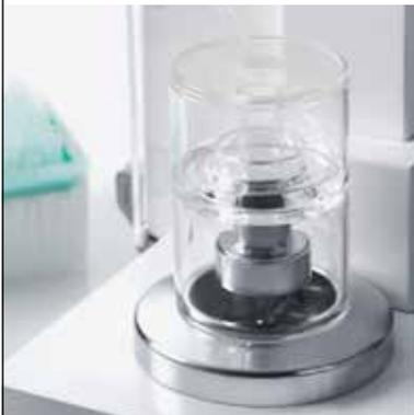
Las trampas de evaporación de vidrio permiten realizar calibraciones rápidas de 20 microlitros a 2 mililitros, gracias a la instalación estable, buena visibilidad y contenedor de residuos independiente.
