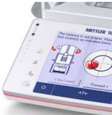
El sistema LevelGuide™ le advierte siempre que la balanza de XPE no está nivelada. La pantalla táctil muestra instrucciones completas y una burbuja de nivelación gráfica para que pueda realizar la calibración en cuestión de segundos.
