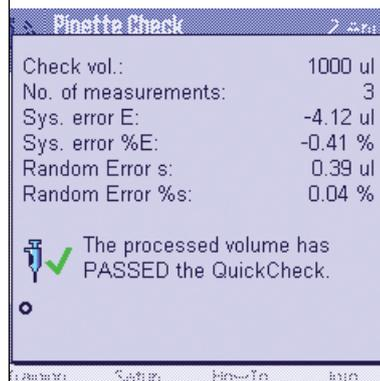
Use el módulo de formación incorporado y la comprobación de pipeta para formar a los usuarios o compruebe las pipetas independientemente del sistema. Los usuarios reciben instrucciones que les guían por todo el proceso y se puede hacer un seguimiento del rendimiento individual.
