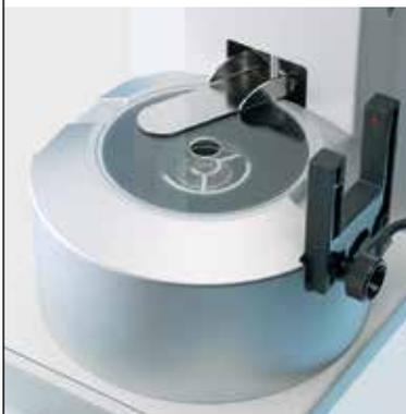
El contenedor de 10 ml permite realizar numerosas calibraciones en un amplio intervalo desde 1  $\mu\text{l}$  o superior sin interrupciones. Se incluye una bomba de aspiración para vaciar el contenedor de aguas residuales de forma sencilla.
