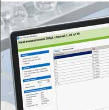
El software Calibry guía todos los pasos del proceso de calibración. La pantalla de la cabina de gran tamaño durante la calibración garantiza un proceso de calibración de todas las pipetas sencillo y seguro.
