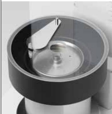
Simplemente, cambie la trampa para calibrar los volúmenes de 2 a 10 mililitros. El contenedor de evaporación de 100 mililitros de metal se intercambia con facilidad en la balanza analítica de XPE.
