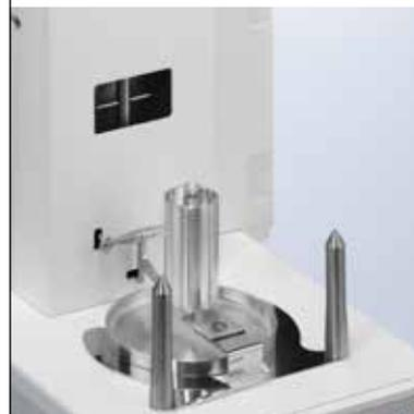
Gracias al diseño exclusivo de los platos de pesaje colgantes, la placa inferior está completamente sellada y evita que el agua o cualquier otro líquido se derrame en la parte mecánica de la balanza y en la célula de carga, para obtener un rendimiento de vida útil duradero y constante.
