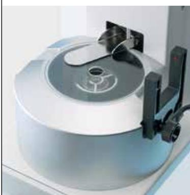
Le grand conteneur de 10 mL permet de nombreux étalonnages dans une large plage, à partir de 1  $\mu\text{L}$  ou plus sans interruption. La pompe aspirante incluse permet de vider facilement le conteneur à déchets.
