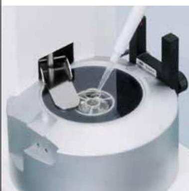
Le couvercle à capteur de mouvement et le grand piège anti-évaporation de 80 mL du modèle XPE26PC réduisent la manipulation et permettent des résultats rapides et stables, même en cas d'étalonnage de micro-pipettes jusqu'à 1  $\mu\text{L}$  conformément à la norme ISO 8655.
