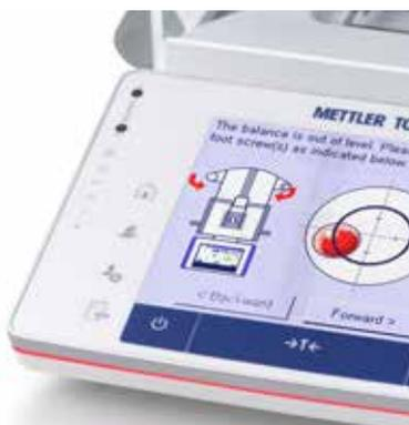
La fonctionnalité LevelGuide™ vous avertit lorsque la balance XPE n'est pas de niveau. Des instructions détaillées et une bulle graphique s'affichent sur l'écran tactile pour vous permettre de procéder à l'étalement en quelques secondes.
