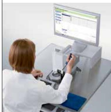
Une table de pesée facultative à double cadre minimise les vibrations dues à l'environnement ou à l'utilisateur, afin d'accélérer considérablement la mesure. Avec cette solution complète, vos étalonnages de pipettes sont encore plus rapides.
