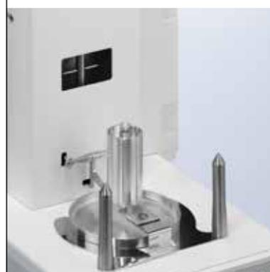
Grâce à son plateau de pesée suspendu unique, la plaque du bas est entièrement hermétique et empêche l'eau ou les liquides de couler à l'intérieur de la balance et de la cellule de pesée, pour des performances durables et constantes.
