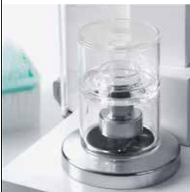
Les pièges anti-évaporation en verre permettent des étalonnages rapides de 20  $\mu\text{L}$  à 2 mL, grâce à la configuration stable, à la bonne visibilité et au conteneur à déchets indépendant.
