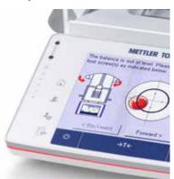
La funzione LevelGuide™ mostra un avviso quando la bilancia XPE non è in bolla. Istruzioni complete e una livella a bolla grafica vengono visualizzate sul touchscreen per eseguire la taratura in pochi secondi.
