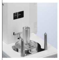
Grazie all'esclusivo design del piatto di pesata sospeso, la piastra inferiore è completamente sigillata e impedisce all'acqua o ai liquidi di penetrare all'interno dei componenti meccanici e della cella di pesata della bilancia, per prestazioni durature e costanti nel tempo.
