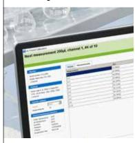
Il software Calibry vi assiste in tutti i passaggi della procedura di taratura. Lo schermo di grandi dimensioni assicura un processo di taratura semplice e protetto per tutte le pipette.
