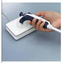
E' sufficiente scansionare il chip RFID delle pipette per visualizzare una panoramica delle attività o per avviare una taratura.
