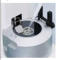
Il coperchio con sensore di movimento e la grande trappola anti-evaporazione da 80 ml di XPE26PC riducono le fasi di manipolazione garantendo risultati rapidi e stabili persino durante la taratura di micropipette nell'ordine di 1 µl conformemente alla norma ISO 8655.
