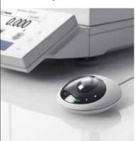
Potete ottimizzare il processo con un sensore di movimento opzionale da posizionare liberamente sul banco di lavoro per un funzionamento a mani libere della bilancia senza alcun rischio di contaminazione.
