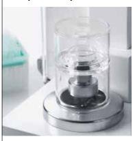
Grazie a una configurazione stabile, un'eccellente visibilità e un vassoio di raccolta indipendente, le trappole anti-evaporazione in vetro consentono tarature rapide da 20 microlitri a 2 millilitri.
