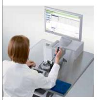
Un tavolo di pesata opzionale a doppio telaio riduce al minimo le vibrazioni generate dall'operatore o dall'ambiente, velocizzando notevolmente i tempi di misura. Prima di questa soluzione completa, la taratura delle pipette non era mai stata così veloce.
