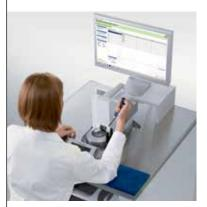
选配的双框架称量台可最大限度减小任何用户或环境振动, 从而大幅提高测量速度。使用这一整套解决方案,可确保前所未有的移液器校准速度。
