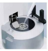
XPE26PC 配有红外传感器盖子和 10 ml 大容量防蒸发阱,即使在按照 ISO 8655 要求校准容量低至 1 µl 的微量移液器时,也可减少操作步骤和确保快速稳定的结果。
