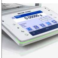
内置 StotusLight™ 状态指示灯通 过颜色直观指示天平的状态。 绿灯清晰指示天平准备就绪, 可开始下一次校准, 以确保结果 有效。
