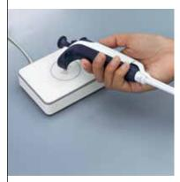
只需将含 RFID 的 Rainin 移液器 进行扫描即可生成任务概览或者 直接开始校准。
