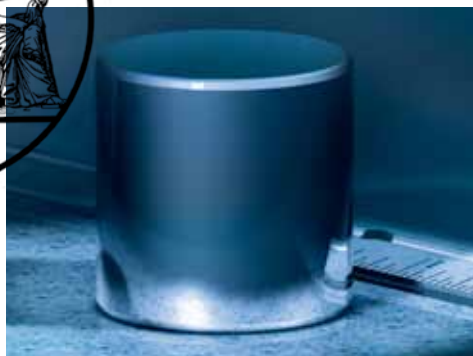
Internationales Ur-Kilogramm (IPK) bei BIPM, ein Zylinder aus 90 % Platin und 10 % Iridium.
