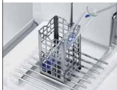
ErgoClip 易巧称量篮的法拉第笼效应保护称量传感器不受带有静电电荷的样品和容器的影响，所有分析天平都标配。
