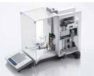
称量传感器和电子元件安装在天平背部。您不会受到称量室里热力因素和溅出样品的影响，可确保持续可靠的性能。
