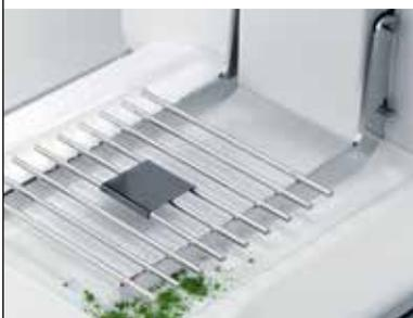
SmartGrid 最大限度地减小气流的影响，从而显著缩短稳定时间。溅出的物质从网格掉落，不会影响称量结果。
