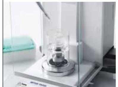
对于常规移液器测试而言，防蒸发并显著减少测试液体的水分损失，并可在数秒内安装到您的天平上。
