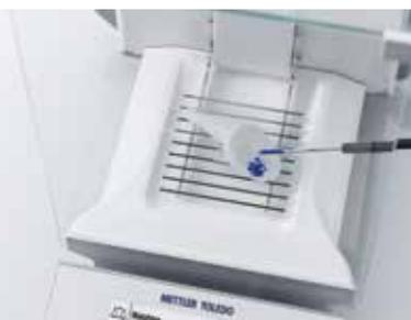
SmartPrep™ 一次性防静电漏斗可确保粉末称量的安全性，并加快称量速度。轻松称量、转移和冲洗。符合几乎所有标准 5 – 250 mL 烧瓶。
