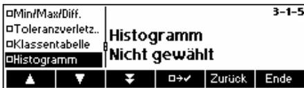
Histogramm im Bericht ausdrucken. Ein Histogramm ist eine grafische Darstellung der Verteilung. Die Fläche der Rechtecke ist proportional zur Anzahl Einzelwerte in den Klassen. Der Bereich von Nominal bis T1 ist in 4 Klassen eingeteilt, von T1 bis T2 (falls vorhanden) in 2 Klassen und von T2 bis T3 (falls vorhanden) in eine Klasse. Das Histogramm sieht folgendermassen aus:
