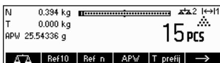
**A granel** La segunda báscula se utiliza exclusivamente como peso a granel. El APW se calcula utilizando el peso colocado en la primera báscula (báscula Smart Count), independientemente de la báscula que esté activa; así, el peso de la segunda báscula se utilizará para contar. Esto se utiliza si la muestra tiene un peso superior a la carga máxima de la báscula Smart Count.
