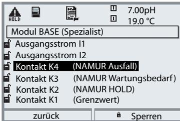
**NAMUR-Signale:** Lieferzustand der Kontaktbelegung
