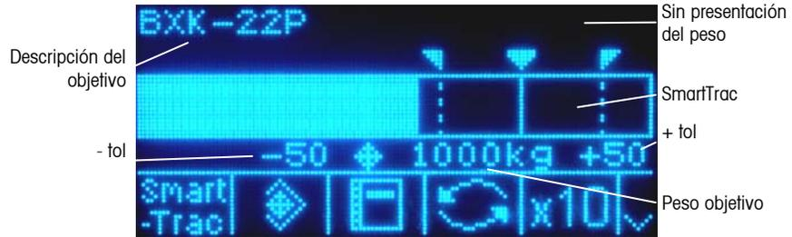
Figure 2-14: Tamaño grande de SmartTrac para transferencia de materiales
