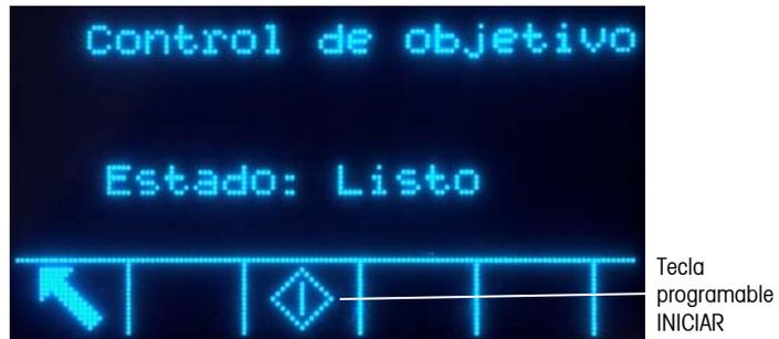
Figura 2-9: Ejemplo de condición lista en el control del objetivo
