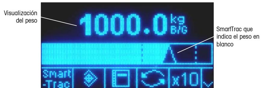
Figure 2-12: Tamaño pequeño de SmartTrac para transferencia de materiales
