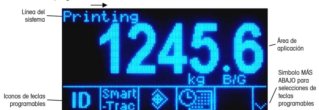
Figura 2-8: Pantalla de operación de pesaje predeterminada
