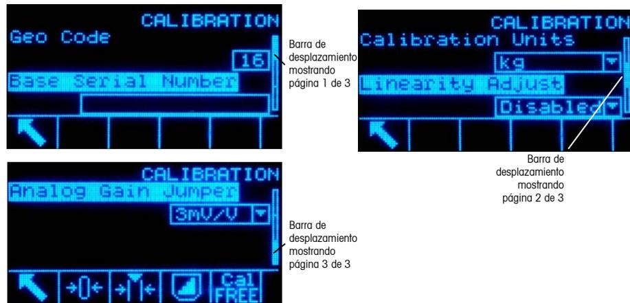
**Figura 2-3: Ejemplo de barras de desplazamiento que indican tres páginas de campos para configuración**
