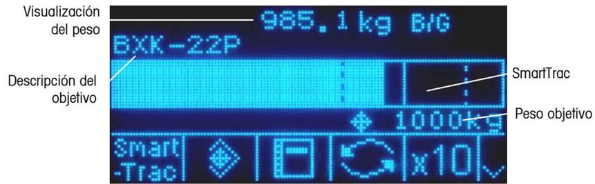
Figure 2-13: Tamaño mediano de SmartTrac para transferencia de materiales
