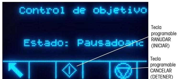
Figura 2-11: Ejemplo de condición pausada en el control del objetivo
