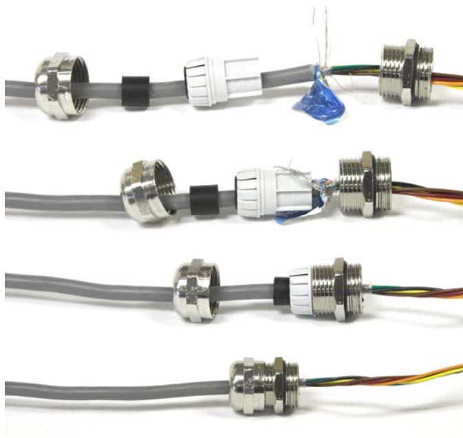
Figure 2-5: Construction des prises de câble
