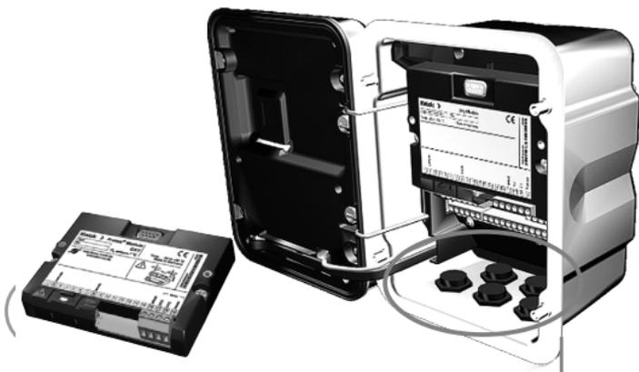
Encima de los bornes de conexión 2 y 8 se halla una tapa de blindaje. Para conectar los cables del sensor basta con levantar la tapa.
