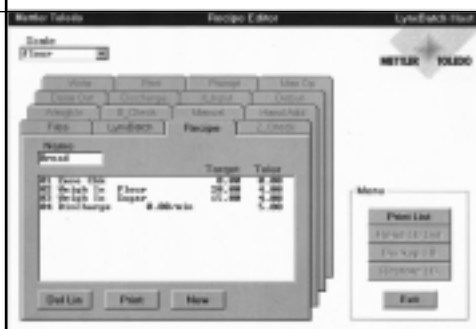
El programa DATAVAULT del controlador LYNXBATCH edita y almacena archivos de recetas y componentes, y se comunica hasta con 8 controladores LYNXBATCH.
