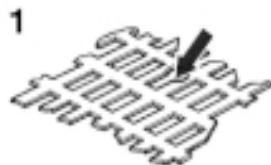
Vérifier si la grille de protection de votre LP16-M présente une ouverture en forme de trou de serrure, conformément à la **figure1**.
