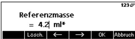
Bringen Sie, um den Faktor automatisch zu berechnen, das Wägegut auf die Waage auf, drücken Sie die Funktionstaste «**Ermitteln**» und geben Sie die Referenzmasse ein.
