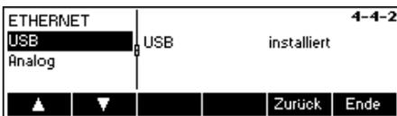
Der Zustand der USB- Option wird angezeigt. Ein weiteres Konfigurieren der USB-Schnittstelle innerhalb des Vision Setups entfällt.
