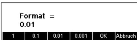
Um die Auflösung der Anzeige zu ändern, drücken Sie die Funktionstaste «**Format**» und wählen Sie das gewünschte Format aus.
