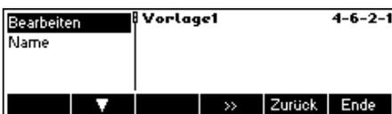
Es besteht zudem die Möglichkeit, „Vorlagen“ zu erzeugen. Wählen Sie dazu die zu bearbeitende Vorlage und drücken Sie «>>>». Wählen Sie **«Bearbeiten»** und drücken Sie «>>>», um die Einstellungen dieser Vorlage zu ändern. Wählen Sie „Name“ und drücken Sie **«Bearb.»**, um diese Vorlage zu benennen.
