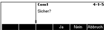
Drücken Sie **«Ja»**, um die Einstellungen des aktuellen COM Port zurückzusetzen. Wird „Sicher?“ angezeigt, bestätigen Sie mit **«Ja»**. Der ausgewählte COM Port wird nun auf seine ursprünglichen Werkseinstellungen zurückgesetzt.
