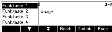
Wählen Sie die Funktionstaste aus, die definiert werden soll und drücken Sie «**Bearb.**». Es ist möglich, bis zu 30 Funktionstasten zu definieren.
