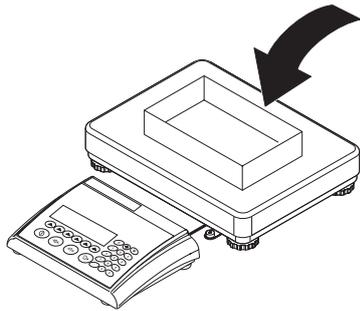
Bringen Sie den **leeren** Behälter auf die Waage auf und tarieren Sie mit der Taste «→T←».
