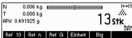
IND465 ist nun zur Stückzählung bereit, unter Einbeziehung des optimierten (mittleren) Stückgewichts.
