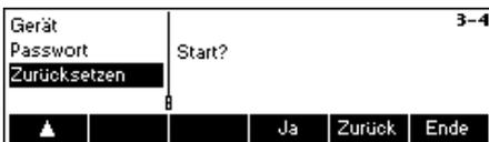
Drücken Sie «**Ja**», um die Terminaleinstellungen zurückzusetzen. Wird „START?“ angezeigt, bestätigen Sie mit der Taste «**Ja**». Die Terminaleinstellungen sind nun auf die ursprünglichen Werkseinstellungen zurückgesetzt.
