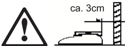
Ist das **Anschlusskabel** beschädigt, darf die Waage nicht mehr betrieben werden. Prüfen Sie deshalb das Kabel in regelmäßigen Abständen und vergewissern Sie sich, dass an der Waagenrückseite ein Abstand von ca. 3 cm eingehalten wird, damit das Kabel nicht zu sehr abgeknickt wird.
