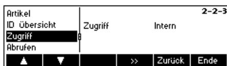
**Zugriff** - Steht diese Funktion auf „Intern“, berücksichtigt BBA462 / BBK462 Count nur die eigene Datenbank. Steht diese Funktion auf „Extern“ wird eine externe Datenbank abgefragt. Die eigene interne Datenbank wird in diesem Fall nicht berücksichtigt. Dies ist der Fall wenn die BBA462 / BBK462 in „Host-Modus“ betrieben wird und als Satellit fungiert.
