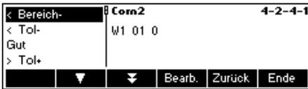
Wählen Sie **<Bereich-**, **< Tol-**, **Gut**, **> Tol+**, **>Bereich+**, **Ausgänge Aus** oder **Zurücksetz. I/O** und drücken Sie die Taste **«Bearb.»**, um die Befehle zu definieren.
