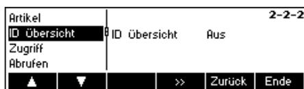
**ID Übersicht** - Ist diese Funktion auf „Ein“ eingestellt, kann mit der Datenbank- Taste direkt auf die ID's zugegriffen werden.
