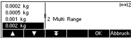
Wählen Sie mit den Tasten «▲» und «▼» die gewünschte Auflösung und drücken Sie «OK». Bei Mehrbereichswaagen steht die Auflösung 'd1' zweimal (modellabhängig), als Single Range (Einbereich) oder als Multi Range (Mehrbereich) zur Verfügung (das Symbol befindet sich in der Ecke oben rechts).
