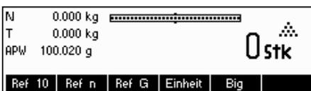
Die Waage hat das eingegebene Stückgewicht gespeichert und ist nun bereit zur Stückzählung.
