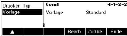
Falls Sie „Vorlagen“ für Ihre Ausdrücke verwenden wollen, können Sie diese jetzt ebenfalls der entsprechenden Datenschnittstelle zuweisen. Wählen Sie dazu „Vorlage“ und drücken Sie die Taste «**Bearb.**». (Vorlagen können im „Vision Setup“- Menü unter „KOMMUNIKATION → Def. Ausdruck“ angelegt werden.)
