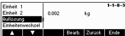
Wählen Sie „**Auflösung**“ (**diese Funktion steht nicht bei allen Modellen zur Verfügung**), um die Einstellungen der Waagenauflösung zu ändern.
