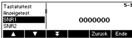
Die **Seriennummer** der Waage wird angezeigt.
