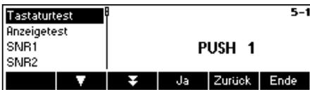
Drücken Sie alle 25 Tasten nacheinander. Funktioniert eine Taste, springt die Waage zur nächsten Taste. Die Tasten sind wie folgt nummeriert:
