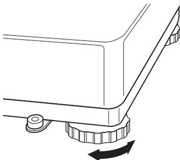
Drehen Sie die Stellfüße, damit die Waage horizontal steht. Ist eine Libelle vorhanden, muss sich deren Luftblase im Zentrum befinden.
