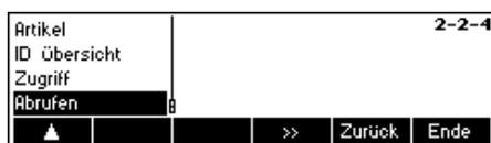
**Abrufen** - Diese Funktion ermöglicht das Aufrufen eines Datenbankartikels direkt über einen Softkey. D.h. mit einem Tastendruck kann ein zuvor bestimmter Artikel geladen werden.
