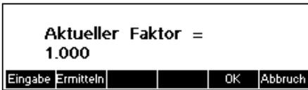
Der Faktor kann entweder manuell eingegeben werden oder aus dem Gewicht der aufgebrauchten Wägegüter berechnet werden. Drücken Sie dazu die Taste «**Faktor**». Zur manuellen Eingabe drücken Sie bitte «**Eingabe**». Wenn der Faktor aus dem aufgelegten Gewicht berechnet werden soll, drücken Sie bitte «**Ermitteln**».
