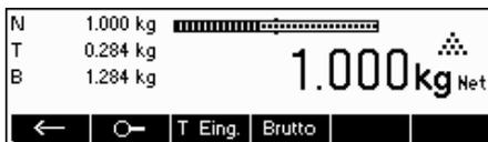
Drücken Sie die Taste «**Brutto**». Mit dieser Funktion wird das Bruttogewicht angezeigt (das Symbol „**B**“ erscheint und ersetzt das „**Net**“-Symbol).
