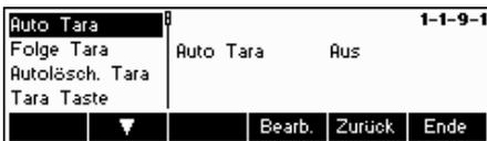
Schalten Sie die verfügbaren Funktionen **Auto Tara, Folge Tara, Autolöschen Tara oder Tara Taste** entweder Ein oder Aus.
