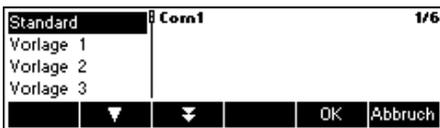
IND465 bietet Ihnen die Möglichkeit, bis zu fünf benutzerdefinierte Vorlagen für Ihren individuellen Ausdruck zu generieren. Diese müssen wie unter Kapitel 5.9.8 beschrieben, im „Vision Setup → KOMMUNIKATION → Def. Ausdruck“ angelegt werden.
