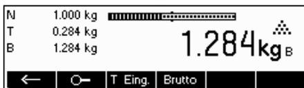
Nach einigen Sekunden kehrt die Waage automatisch zur Nettogewichtsanzeige zurück.
