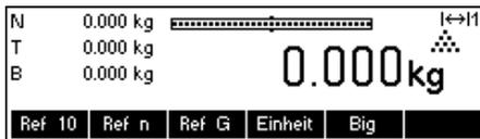
Das Einschalten der Waage führt zu einem Anzeigetest mit kurzer Anzeige aller Segmente und der Software-Version. Sobald die Nullanzeige erscheint, ist die Waage betriebsbereit.
