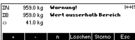
Würde das Zielgewicht bei der Addition eines weiteren Postens überschritten, erschiene eine Warnmeldung. Eine weitere Summierung ist nicht möglich.
