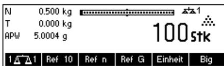
**Referenzwaage** Die Zweitwaage wird ausschließlich zur Referenzgewichtsbestimmung eingesetzt. Das mittlere Stückgewicht wird, ungeachtet der aktiven Waage, aus dem auf die Zweitwaage aufgebrachten Gewicht errechnet. Dies ist der Fall, wenn die Zweitwaage (z. B. eine Analysewaage) eine feinere Auflösung als das IND465 besitzt, um so ein genaueres Stückgewicht zu erhalten.
