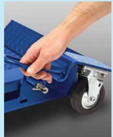
La báscula portátil de 762x762 mm pasa fácilmente a través de entradas de puertas estándares. Las rampas de bisagras se doblan y no estorban cuando la báscula se cambia de sitio o se guarda.
