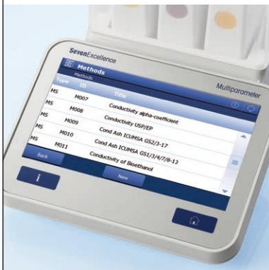
Zusätzlich zu mehr Sicherheit, höherer Reproduzierbarkeit durch identische Einstellungen und mehr Komfort ermöglichen es Ihnen Methoden auch, spezielle Anwendungen für Leitfähigkeitsmessungen auszuführen. Diese umfassen die USP/EP-Messung von Reinwasser mit Grenzwertüberwachung und Leitfähigkeitsasche-Messungen gemäss zwei ICUMSA-Vorschriften.
