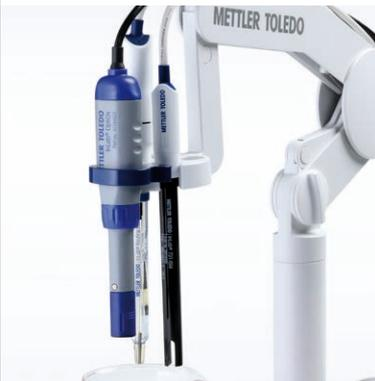
Die SevenExcellence-Serie ermöglicht die gleichzeitige Messung von 1, 2 oder 3 Parametern wahlweise in einer oder verschiedenen Proben. Bei Mehrkanal-Messungen kann das Temperatursignal von einem Modul für alle anderen Module verwendet werden, um identische Temperaturmesswerte zu garantieren!
