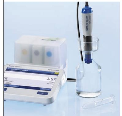
Der BSB-Gehalt von Abwasser kann sehr einfach gemessen werden. Mit dem speziellen BSB-Adapter eignet sich der Sensor für die Messung in allen gängigen BSB-Flaschen. Gemäss EPA (Environmental Protection Agency, USA) muss dazu dank RDO-Technologie nicht einmal gerührt werden. Mit dem S900-BOD-Kit können Sie sofort loslegen.
