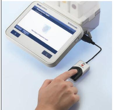
Zusätzlich zur Eingabe von Kennwörtern unterstützt das Instrument auch den externen LogStraight™ Fingerabdruckleser. Dies bietet nicht nur eine komfortable Lösung für die Anmeldung, sondern auch ein zusätzliches Mass an Sicherheit!
