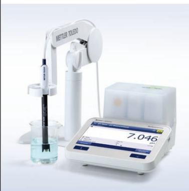
uPlace™: Der Elektrodenarm führt eine perfekte vertikale Bewegung aus und kann einhändig bedient werden. Dies beschleunigt die Messungen und senkt das Risiko, Probengefäße umzukippen und Sensoren zu beschädigen.
