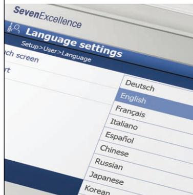
Der kapazitive 7-Zoll-Touchscreen mit übersichtlichen Schaltflächen und einer intuitiven Menüstruktur ermöglicht eine schnelle und einfache Bedienung des Instruments. Das Menü ist in 10 Sprachen verfügbar und enthält nicht einen einzigen kryptischen Ausdruck!
