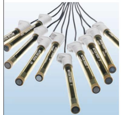
Das SevenExcellence ist mit unserer perfectION™ Produktreihe kombinierter ionenselektiver Elektroden und mit unseren Halbzellen einsetzbar. Für Messungen mit Halbzellen steht ein Eingang für den Anschluss einer Referenzelektrode zur Verfügung.
