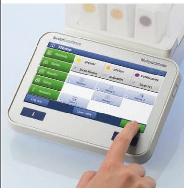
Neben Methoden bietet dieses Instrument eine zweite Möglichkeit zum Starten einer Messung oder Kalibrierung, indem Sie auf READ oder CAL drücken. Obwohl sie flexibler sind, erfordert die Durchführung von mehreren Direktmessungen mit verschiedenen Parametern eine Änderung der Einstellungen vor jeder Probe.
