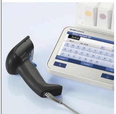
Die Touchscreen-Bedienung des Instruments ermöglicht die schnelle und bequeme Eingabe von Text wie zum Beispiel Proben-IDs. Um die Effizienz zusätzlich zu steigern, können Sie auch einen USB-Barcodeleser oder verwenden.
