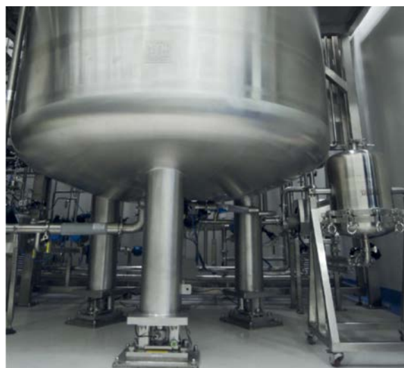
Seção inferior do reator montada em módulos de pesagem de compressão flexíveis
