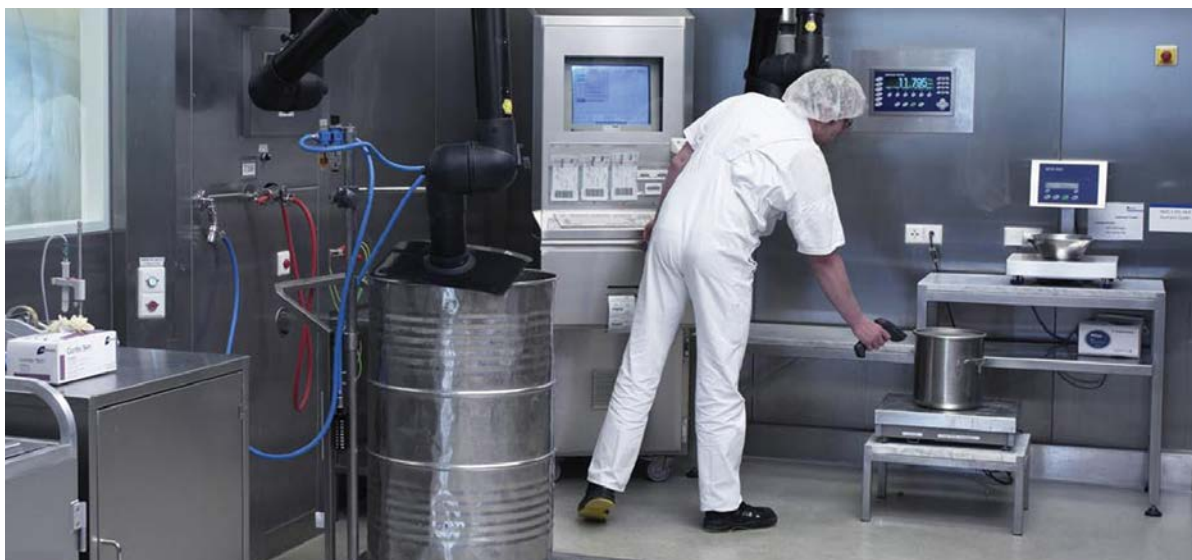
Figura 8: Pesagem de materiais adicionados manualmente fora da linha
