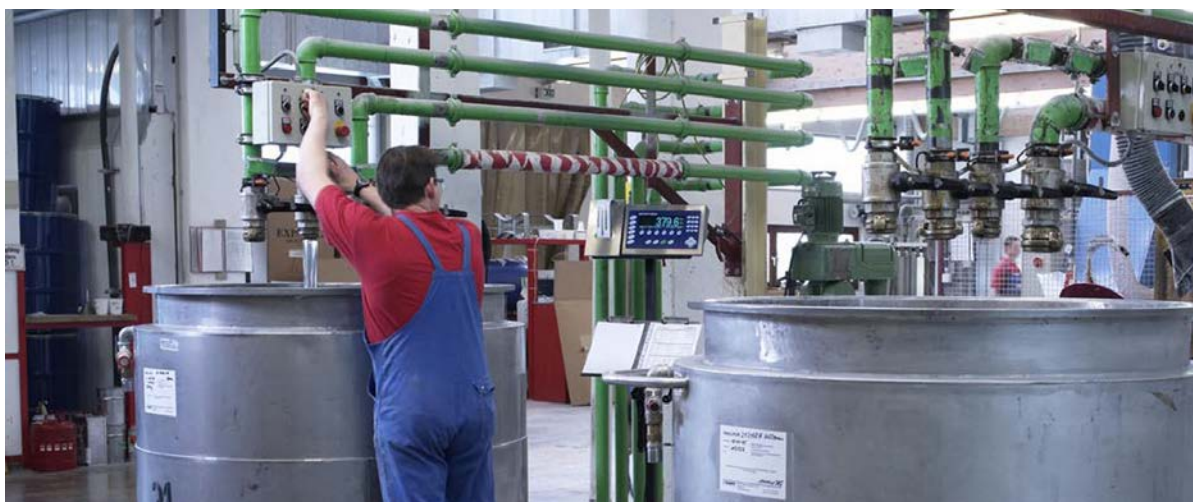
Figura 27: Operação de enchimento manual
