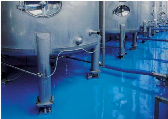
Abb. 1: Typische Tankwaage
