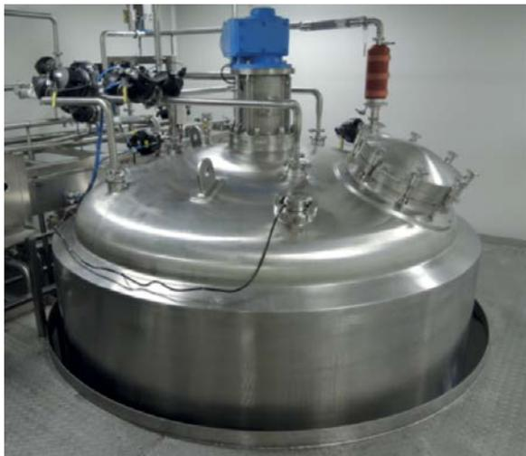
Der obere Abschnitt des Reaktors reicht in das nächste Geschoss und verfügt über ausreichend Bewegungsspielraum
