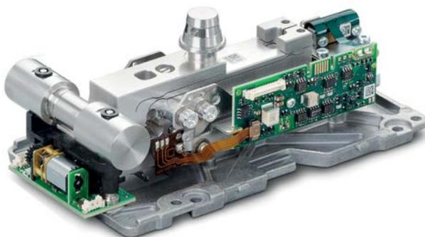
Wägezelle mit elektromagnetischer Kraftkompensation (EMK) und hoher Auflösung für unübertroffene Präzision.
