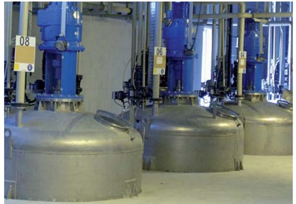
Abb. 2: In den Boden eingelassene Tankwaage
