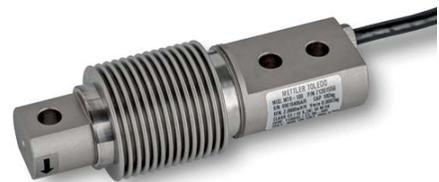
Hermetisch abgedichtete Stabwägezelle mit DMS-Technologie. Diese Wägezellen sind üblicherweise für einen Bereich von 5 kg bis 5 t geeignet.
