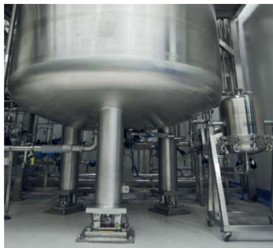
Partie inférieure du réacteur installé sur des modules de pesage par compression flexibles
