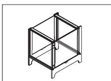
Pare-brise MS-DS-21 pour les modèles avec précision d'affichage de 10 mg à 100 mg.
