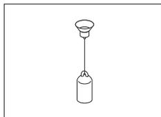
Plongeur pour la masse volumique des liquides combiné à un kit de masse volumique
