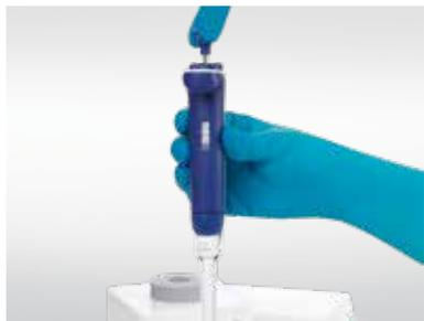
1. Réglez la pipette à son volume nominal, puis, en utilisant de l'eau distillée ou déionisée, pipetez ce volume dans le réservoir de SmartCheck.
