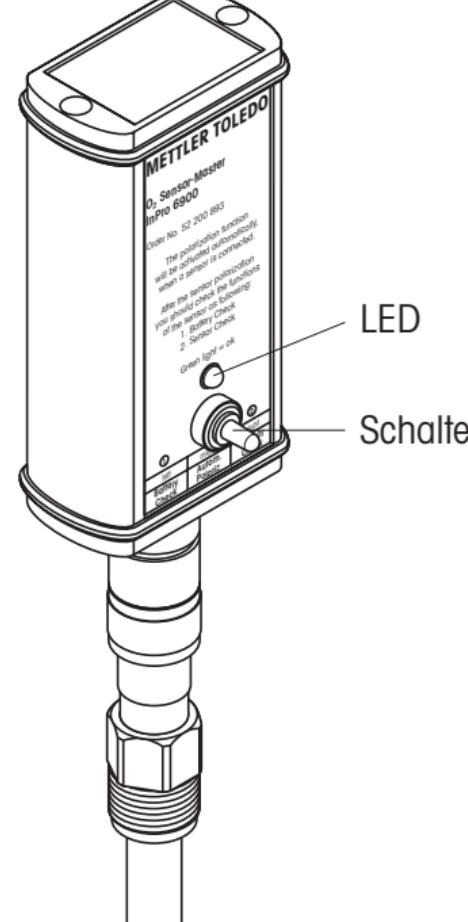
Sobald der Sensor am O<sub>2</sub> Sensor-Master angeschlossen ist, wird automatisch die Polarisierungsfunktion aktiviert und der Sensor mit der richtigen Polarisationsspannung versorgt. Falls der Sensor für mehr als 5 Minuten vom Transmitter getrennt war, muss er zuerst polarisiert (Polarisationszeiten siehe «Kapitel 5.1») werden, bevor aussagekräftige Testresultate erzielt werden.
