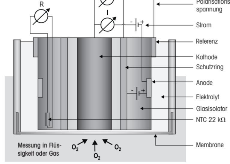
Als Folge davon fliesst zwischen Kathode und Anode ein Strom (4 Elektronen pro O<sub>2</sub>-Molekül), der proportional zum O<sub>2</sub>-Partialdruck an der Kathode ist.
