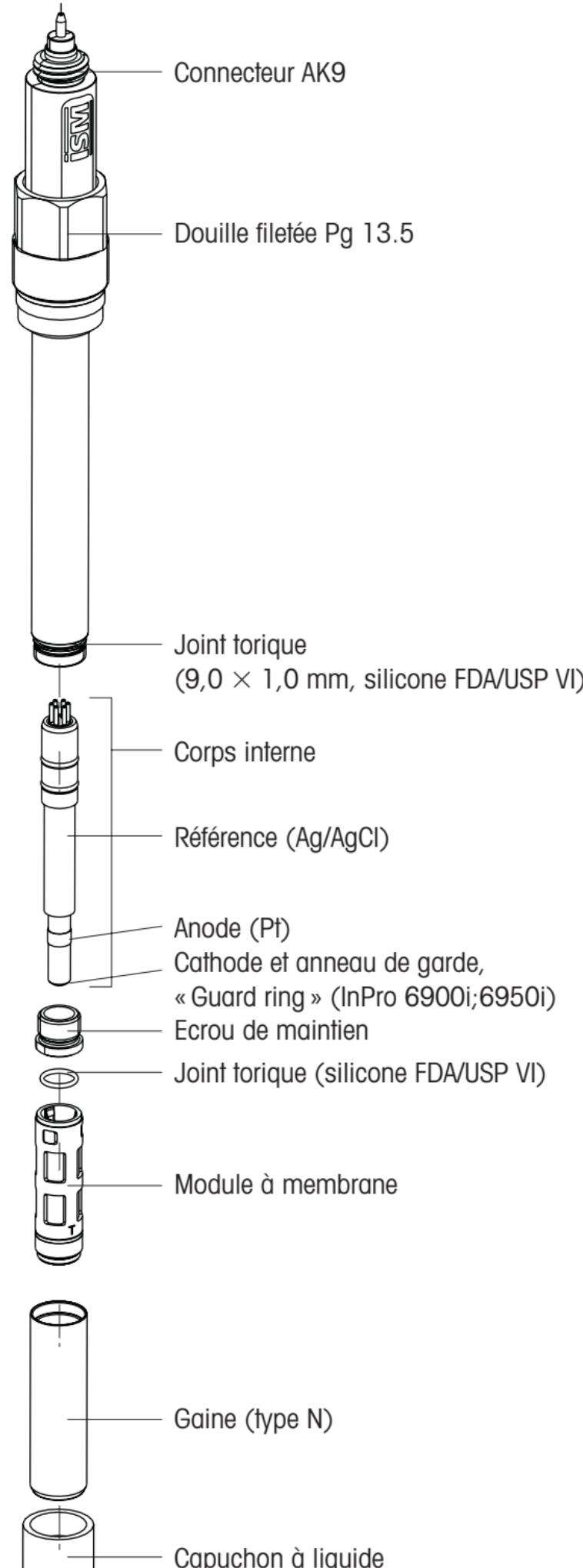
Les sondes ISM O<sub>2</sub> METTLER TOLEDO sont livrées avec module à membrane monté, sans électrolyte et avec capuchon de protection placé. Leur fonctionnement a été testé.
