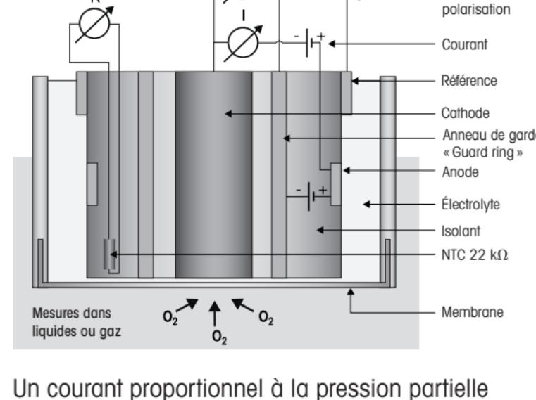
Un courant proportionnel à la pression partielle d'O<sub>2</sub> au niveau de la cathode circule donc entre la cathode et l'anode (à raison de 4 électrons pour chaque molécule d'O<sub>2</sub>).
