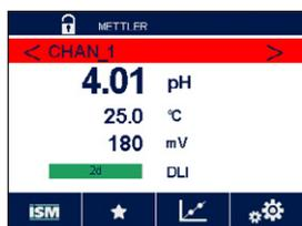
Bedingungen, die einen Alarm auslösen, werden durch einen roten Balken angezeigt. Wenn der betroffene Kanal in der aktuellen Menüansicht oder auf dem Startbildschirm angezeigt wird (siehe Kapitel 3.2 «Anzeige»), erscheint der rote Balken in der Zeile mit der Kanalanzeige. Eine Alarmmeldung wird aufgezeichnet und kann über das Menü «Meldungen» (PFAD: \ ISM \ Messages; siehe auch Kapitel 9.2 «Meldungen») aufgerufen werden.
