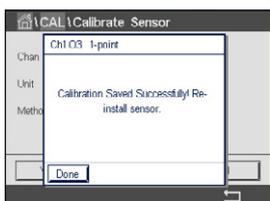
Wurden «Justierung» oder «Kalibrierung» ausgewählt, wird «Kalibrierung erfolgreich gespeichert» angezeigt. In jedem Fall wird die Meldung «Bitte Sensor neu installieren» angezeigt. Nach Drücken der Schaltfläche «Fertig» kehrt der M800 zum Kalibrieremenü zurück.
