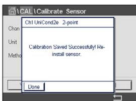
Wurde «Kal. speichern» ausgewählt, wird «Kalibrierung erfolgreich gespeichert» angezeigt. In jedem Fall wird die Meldung «Bitte Sensor neu installieren» angezeigt. Nach Drücken der Schaltfläche «Fertig» kehrt der M800 zum Kalibriermenü des Sensors zurück.
