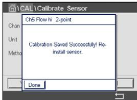
Wurde «Kal. speichern» ausgewählt, wird «Kalibrierung erfolgreich gespeichert» und «Bitte Sensor neu installieren» angezeigt. Nach Drücken der Schaltfläche «Fertig» kehrt der M800 zum Kalibrieremenü zurück.
