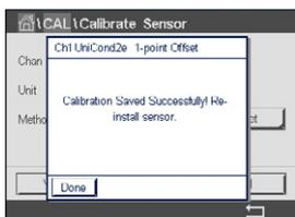
Wurde «Kal. speichern» ausgewählt, wird «Kalibrierung erfolgreich gespeichert» angezeigt. In jedem Fall wird die Meldung «Bitte Sensor neu installieren» angezeigt. Nach Drücken der Schaltfläche «Fertig» kehrt der M800 zum Kalibrierermenü des Sensors zurück.
