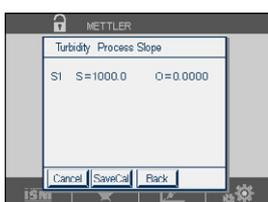
Als Ergebnis der Kalibrierung wird in der Anzeige der Wert für Steilheit und Nullpunktverschiebung (Offset) dargestellt.
