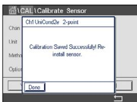
Wurde «Kal. speichern» ausgewählt, wird «Kalibrierung erfolgreich gespeichert» angezeigt. In jedem Fall wird die Meldung «Bitte Sensor neu installieren» angezeigt. Nach Drücken der Schaltfläche «Fertig» kehrt der M800 zum Kalibrierenmenü des Sensors zurück.
