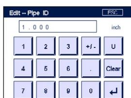
Um die Schleichmengenunterdrückung auszuwählen, wählen Sie die Option **Flow Cut**. Das M800 zeigt ein Tastenfeld an, mit dem der Wert geändert werden kann. Wenn der Messwert geringer ist als der eingegebene Wert für die Schleichmengenunterdrückung, setzt der Transmitter M800 den Durchflussmesswert auf 0. Mit der  $\leftarrow$ -Taste übernehmen Sie den Wert.
