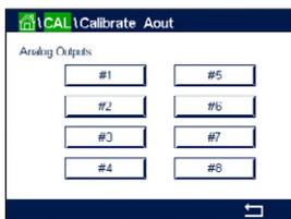
Jeder Analogausgang kann auf 4 und 20 mA kalibriert werden. Wählen Sie das gewünschte Ausgangssignal für die Kalibrierung durch Drücken der entsprechenden Schaltfläche («#1» für Ausgangssignal 1, «#2» für Ausgangssignal 2 usw.).
