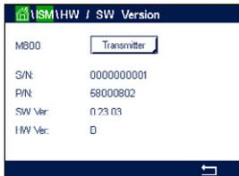
Die Daten des Transmitters werden auf dem Bildschirm angezeigt. Drücken Sie das Eingabefeld in der Zeile für **M800**. Um die Daten der gewünschten Karte oder des Transmitters selbst auszuwählen, drücken Sie das entsprechende Feld.
