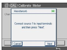
Schließen Sie Quelle 1 an die Eingangsklemmen an. Jeder Widerstandsbereich beruht auf einer Zweipunktkalibrierung.
