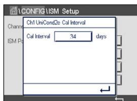
Drücken Sie das Eingabefeld neben **Kal.-Intervall** und geben Sie den Wert für das Kalibrierintervall ein. Anhand dieses Wertes berechnet der Transmitter die verbleibende Zeit bis zur nächsten Kalibrierung (TTCal). Mit der ←-Taste übernehmen Sie den Wert. Der neue Wert wird nach Übernahme der Änderungen im Sensor gespeichert.
