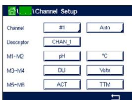
Wählen Sie den einzurichtenden **Kanal** durch Drücken der entsprechenden Schaltfläche («#1» für Kanal 1, «#2» für Kanal 2 usw.).
