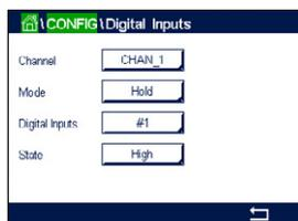
Drücken Sie die zugehörige Schaltfläche für die **Kanalzuordnung** (Kan\_). Wählen Sie den Kanal, der mit dem digitalen Eingangssignal verknüpft werden soll.
