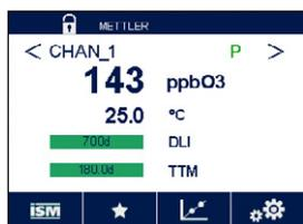
Nach der Bestimmung des O<sub>3</sub>-Gehalts der Probe, drücken Sie auf das Kalibriersymbol, um die Prozesskalibrierung abzuschließen.
