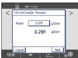
Drücken Sie auf das Eingabefeld für **Punkt 1** und geben Sie den Leitfähigkeitswert der Probe ein. Drücken Sie dann die Schaltfläche «Weiter», um die Ergebnisse für die Kalibrierung zu berechnen.
