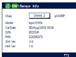
Die Daten des ersten Kanals, an den ein Sensor angeschlossen ist, werden auf dem Bildschirm angezeigt. Drücken Sie das Eingabefeld in der Zeile «Kan». Drücken Sie das zugehörige Feld, um den entsprechenden Kanal auszuwählen und die Daten des gewünschten Sensors einzusehen.
