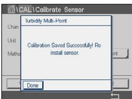
Wurde «Kal. speichern» ausgewählt, wird «Kalibrierung erfolgreich gespeichert» angezeigt. In jedem Fall wird die Meldung «Bitte Sensor neu installieren» angezeigt. Nach Drücken der Schaltfläche «Fertig» kehrt der M800 zum Kalibrieremenü des Sensors zurück.
