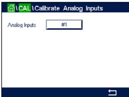
Jeder Analogeingang kann auf 4 und 20 mA kalibriert werden. Drücken Sie die Schaltfläche «#1», um das Eingangssignal für die Kalibrierung auszuwählen.
