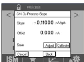
Il display mostra il valore per la pendenza e l'offset come risultato della taratura.
