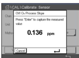
Prelevare un campione e premere il pulsante  $\leftarrow$  per memorizzare il valore di misura attuale. Nella schermata di misura lampeggerà «P» ad indicare che è attiva una taratura di processo.
