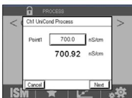
Toccare il campo di immissione accanto a **Punto 1** e inserire il valore di conducibilità del valore. Premere il tasto «Avanti» per avviare il calcolo dei risultati di taratura.
