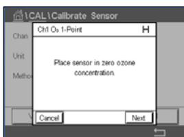
Posizionare il sensore nel gas di taratura, come l'aria, e premere il pulsante «Avanti».
