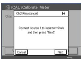
Collegare la sorgente 1 ai terminali di ingresso. Ogni intervallo di resistenza consiste in una taratura a due punti.
