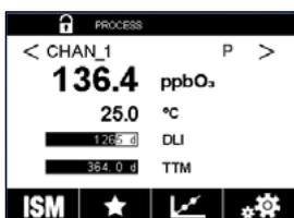
Dopo aver determinato il valore di  $O_3$  del campione, premere l'icona di taratura per completare la taratura di processo.
