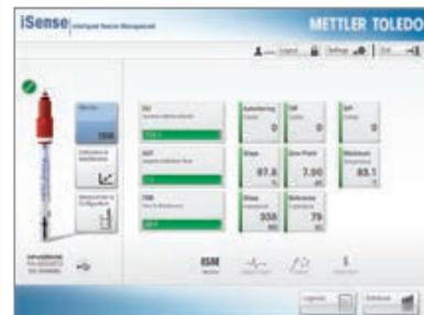
Mit iSense™, dem wichtigsten Instrument von ISM, können die Sensoren über einen PC vorkalibriert und dann mit dem M100 verbunden werden. Eine Benutzerschnittstelle am Einsatzort ist daher nicht mehr erforderlich. Das neue Transmitterkonzept reduziert den Betriebs- und Verdrahtungsaufwand auf ein Minimum.
