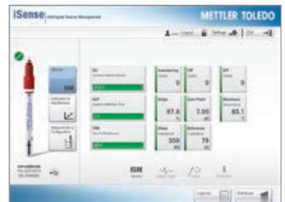
Mit der iSense<sup>™</sup>-Software können die Sensoren über einen PC oder ein tragbares Gerät vorkalibriert und dann mit dem M100 DR verbunden werden. Eine Benutzerschnittstelle am Einsatzort ist daher nicht erforderlich.
