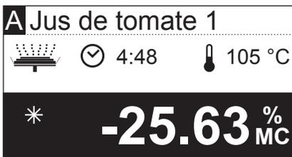
Le résultat de mesure est visualisé sur l'affichage. Des indications sur l'interprétation des résultats de mesure se trouvent dans le chapitre 8.1. Le résultat et l'affichage de la durée restent sur les valeurs finales, alors que la température est toujours actualisée.
