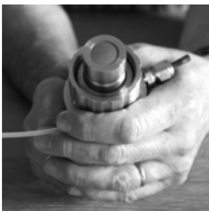
Abb. 7: Sensor mit neuer MembraCap, bereit zur Kalibrierung
