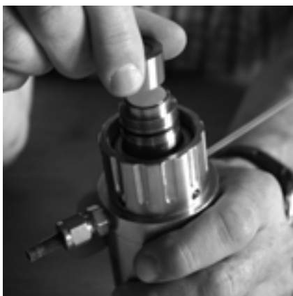
Abb. 5: Neue MembraCap oben am Sensor anbringen
