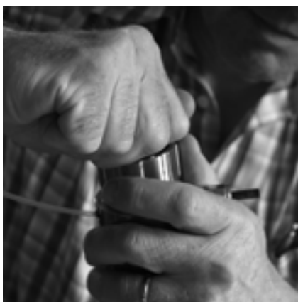
Fig. 6 : Vissage sur le nouveau MembraCap
