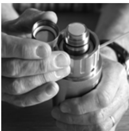
Fig. 3 : Sonde lorsque le MembraCap est enlevé
