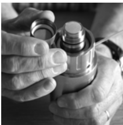
Abb. 3: Sensor ohne MembraCap
