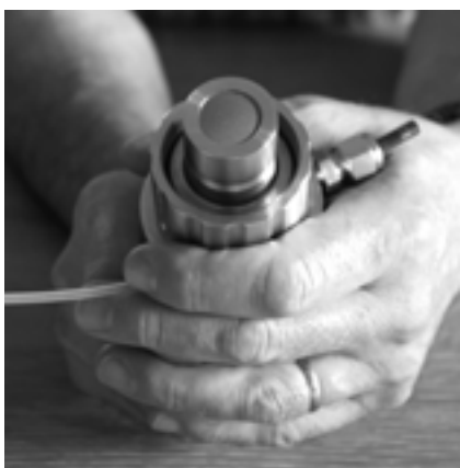
Fig. 7 : Sonde avec le Membracap nouvellement monté, prête pour l'étalonnage
