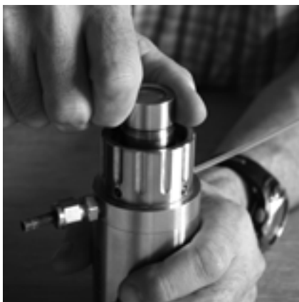
Fig. 4 : Dévissage du MembraCap dans le sens inverse des aiguilles d'une montre
