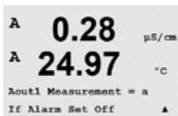
Wird ein Alarmwert eingestellt, so ist dies der Wert, den der analoge Ausgang annimmt, sobald eine Alarmbedingung auftritt.
