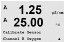
Bevor die Luftkalibrierung erfolgt und um höchste Genauigkeit zu erreichen, ist der Luftdruck und die relative Feuchtigkeit einzugeben, wie in Abschnitt 8.2.3.3 «Konfiguration/Messung/Einstellungen gemäss vorgegebener Parameter/Parameter für gelösten Sauerstoff» beschrieben.
