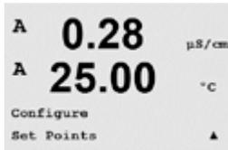
Bis zu 4 Sollwerte (6 bei Modellen mit 2 Kanälen) können für jede Messung (a bis d) festgelegt werden. Mögliche Sollwerte sind Aus (Off), Oberer Sollwert (High), Unterer Sollwert (Low), Ausserhalb der Messgrenzen (Outside) und Zwischen oberem und unterem Sollwert (Between).
