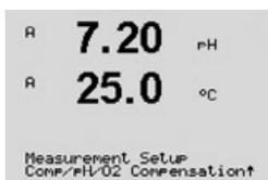
Mehrkanalmodelle: Das Menü «Comp/pH/O<sub>2</sub>» kann mit den Tasten ▲ oder ▼ ausgewählt werden. Mit der Taste ► in die nächste Zeile springen und den Parameter auswählen. Zur Wahl stehen «Compensation» (für Leitfähigkeitsmessung), «pH» und «O<sub>2</sub>». Drücken Sie [ENTER].
