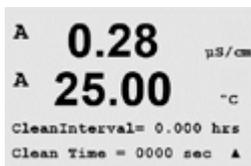
Das Reinigungsintervall kann von 0,000 bis 999,9 Stunden eingestellt werden. Die Einstellung 0 bedeutet, dass der Reinigungszyklus ausgeschaltet ist. Die Reinigungszeit kann von 0 bis 9999 Sekunden eingestellt werden und muss kleiner als das Reinigungsintervall sein.
