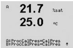
Für den Algorithmus der Prozesskalibrierung ist der zugehörige Druck (ProcCalPres) festzulegen. Dafür kann der Wert des Prozessdrucks (ProcPres) oder des Kalibrierdrucks (CalPres) eingesetzt werden. Wählen Sie den Druck, der während der Prozesskalibrierung auftritt bzw. der für den Algorithmus und den Druck einzusetzen ist.
