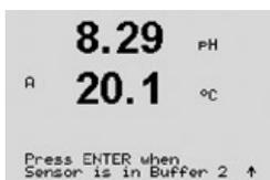
Sobald die Driftbedingungen erfüllt sind, wechselt die Anzeige des Displays und fordert Sie auf, die Elektrode in die zweite Pufferlösung zu stellen.
