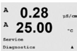
Dieser Menüpunkt ist ein wertvolles Hilfsmittel zur Fehlersuche und bietet Diagnosefunktionen für folgende Punkte: Model/Software Revision (Modell-/Softwareversion), Digital Input (digitaler Eingang), Display, Keypad (Tastatur), Memory (Speicher), Set Relays (Relais einstellen), Set Analog Outputs (analoge Ausgänge einstellen) und Read Analog Outputs (analoge Ausgänge lesen).
