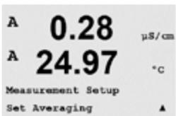
Drücken Sie die Taste [ENTER], um diesen Menüpunkt aufzurufen. Die Durchschnittsbildung (Filterung) kann nun für jede Messwertzeile gewählt werden. Wählbar sind die Optionen Special (Spezial; voreingestellt), None (Keine), Low (Niedrig), Medium (Mittel) und High (Hoch):
