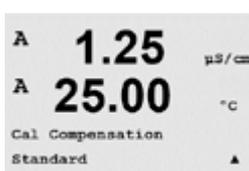
Nach der Wahl der gewünschten Sensorkalibrierung und Drücken der Taste [ENTER] fordert der nächste Bildschirm Sie auf, den Typ des Temperatursgleichsmodus zu wählen, der während des Kalibrierungsprozesses gewünscht wird. Zur Wahl stehen «Standard», «Light 84», «Std 75 °C», «Lin 20 °C = 02,0%/ °C» (vom Benutzer zu wählender Wert), «Lin 25 °C = 02,0%/ °C» (vom Benutzer zu wählender Wert), «Glycol.5», «Glycol1», «Alcohol» und «Nat H<sub>2</sub>O».
