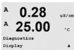
Alle Pixel der Anzeige werden für 15 Sekunden beleuchtet, um eine Fehlersuche in der Anzeige zu ermöglichen. Nach 15 Sekunden kehrt der Transmitter in den normalen Messmodus zurück oder drücken Sie [ENTER], um den Menüpunkt schneller zu verlassen.
