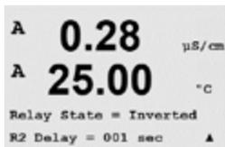
Jedes Alarmrelais kann entweder im Zustand «Normal» oder «Inverted» (Umgekehrt) konfiguriert werden. Zusätzlich kann eine Verzögerung für die Aktivierung gewählt werden. Weitere Informationen finden Sie in Abschnitt 8.4 «Sollwerte».
