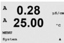
Drücken Sie im Messmodus die Taste ◀. Drücken Sie die Taste ▼ oder ▲, um den Menüpunkt «System» zu wählen und drücken Sie [ENTER].
