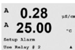
Gehen Sie mit den Tasten ◀ und ▶ zu «Use Relay #» (Relais-Nr. # verwenden). Wählen Sie mit der Taste ▲ oder ▼ das Relais, das für den Alarm verwendet werden soll und drücken Sie [ENTER].
