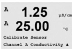
Drücken Sie im Messmodus die Taste [CAL]. Falls das Display Sie zur Eingabe des Sicherheitscodes für die Kalibrierung auffordert, drücken Sie zur Einrichtung dieses Codes auf die Taste ▲ oder ▼. Drücken Sie anschliessend die Taste [ENTER], um den Sicherheitscode für die Kalibrierung zu bestätigen.
