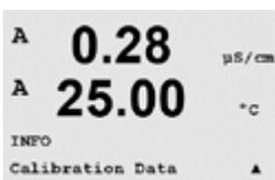
Die Auswahl «Calibration Data» (Kalibrierdaten) zeigt die Kalibrierkonstanten für jeden Sensor an. Mit den Pfeiltasten nach oben/unten wechseln Sie zwischen den Kanälen «A» und «B».
