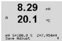
Im Display wird nun der Steilheitsfaktor S und der Verschiebungsfaktor Z der Kalibrierung angezeigt.
