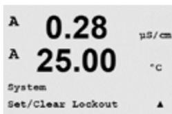
In diesem Menüpunkt können Sie die Sperrfunktion des Transmitters aktivieren/deaktivieren. Der Benutzer wird bei eingeschalteter Sperrfunktion nach seinem Passwort gefragt, bevor er Zugriff auf die Menüs erhält.
