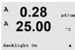
Mögliche Einstellungen sind On, On 50% oder Auto Off 50% (Ein, Ein 50% oder Autom. Aus 50%). Wird «Auto Off 50%» gewählt, schaltet die Beleuchtung nach 4 Minuten auf 50%, wenn keine Taste gedrückt wird. Die Hintergrundbeleuchtung schaltet sich automatisch wieder ein, wenn eine Taste gedrückt wird.
