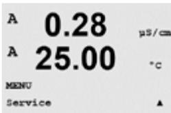
Drücken Sie im Messmodus die Taste ◀. Drücken Sie die Taste ▲ oder ▼, um den Menüpunkt «Service» zu wählen und drücken Sie [ENTER]. Die Optionen zur Systemkonfiguration werden nachfolgend beschrieben.
