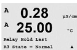
Wählen Sie «Inverted» (Umgekehrt), um den normalen Betriebszustand des Relais umzukehren (d. h. normalerweise offene Kontakte (NO) sind geschlossen und normalerweise geschlossene
