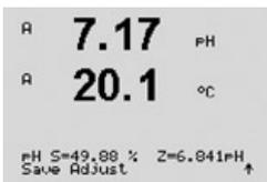
Sobald die Driftbedingungen erfüllt sind, wechselt die Anzeige des Displays und zeigt den Steilheitsfaktor S und den Verschiebungsfaktor Z der Kalibrierung an.
