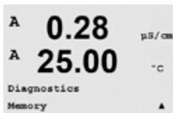
Wenn Sie «Memory» (Speicher) wählen, führt der Transmitter einen RAM- und ROM-Speichertest durch. Testmuster werden von allen RAM-Speicherorten geschrieben und gelesen. Die ROM-Prüfsumme wird neu berechnet und mit dem gespeicherten Wert im ROM verglichen.
