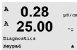
Für die Tastatur-Diagnostik zeigt das Display an, welche Taste gedrückt wird. Wenn Sie [ENTER] drücken, kehrt der Transmitter wieder in den normalen Messmodus zurück.
