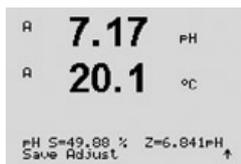
Im Display wird der Steilheitsfaktor S und der Verschiebungsfaktor Z der Kalibrierung angezeigt.
