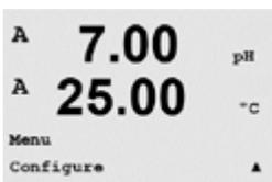
Drücken Sie im Messmodus die Taste [MENU]. Drücken Sie die Taste ▲ oder ▼, um den Menüpunkt Konfiguration zu wählen und drücken Sie [ENTER].
