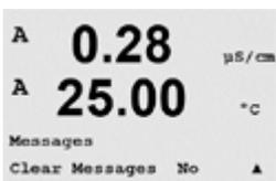
«Clear Messages» (Meldungen löschen) löscht alle Meldungen. Meldungen werden zur Liste der Meldungen hinzugefügt, wenn die Bedingung für die Erzeugung einer Meldung zum ersten Mal auftritt. Werden alle Meldungen gelöscht und eine Meldebedingung besteht immer noch, begann aber vor dem Löschen, so erscheint die Meldung nicht wieder. Damit diese Meldung wieder in der Liste erscheint, muss die Bedingung zunächst verschwinden und dann wieder auftreten.
