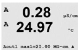
Wenn «Auto-Range» (automatischer Bereich) gewählt wurde, kann Aout1 max1 konfiguriert werden. Aout1 max1 ist der Höchstwert für den ersten Bereich von «Auto-Range». Der Höchstwert für den zweiten Bereich von «Auto-Range» wurde im vorhergehenden Menüpunkt eingestellt. Wenn «Logarithmisch» gewählt wurde, ist auch die Anzahl der Dekaden als «Aout1 # von Dekaden =2» einzugeben.
