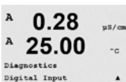
Der Menüpunkt «Digital Input» (Digitaler Eingang) zeigt den Zustand der Digitaleingänge an. Drücken Sie [ENTER], um die Anzeige zu verlassen.
