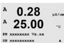
Mit der Taste ▼ navigieren Sie vorwärts durch das Untermenü und können zusätzliche Informationen, wie etwa die aktuelle Softwareversion des Transmitters abfragen: Master V\_XXXX und Comm V\_XXXX); und die Version der Sensor-Firmware (FW V\_XXX) und Sensor-Hardware (HW XXXX).
