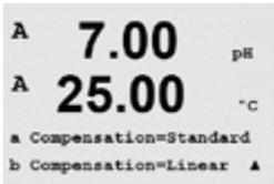
Der Temperaturkompensationsmodus kann für jede der vier Messwertzeilen gewählt werden. Die Temperaturkompensation muss der jeweiligen Anwendung entsprechend eingestellt werden. Gewählt werden kann «Standard», «Light 84», «Std 75 °C», «Lin 20 °C», «Lin 25 °C», «Nat H<sub>2</sub>O», «Glycol.5», «Glycol1», «Cation», «Alcohol» und «Ammonia».
