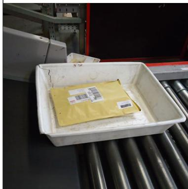
Messen Sie kleinere Artikel, die in Schalen transportiert werden. Mithilfe der Volumenmesstechnik können Schale und Artikel voneinander getrennt werden.
