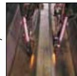
Soldaduras continuas: aseguran que cada viga sea hermética al aire para evitar la corrosión interna.
